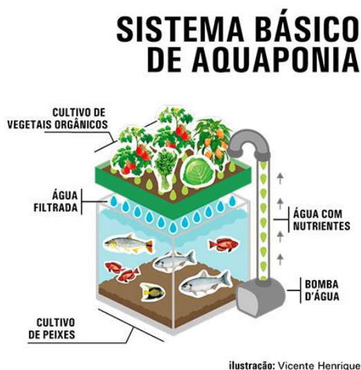
Figura 5: Funcionamento do sistema de aquaponia
