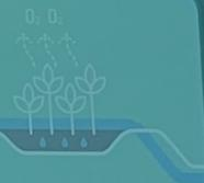
É a primeira etapa do tratamento de efluentes e configura um meio aeróbio. Permite a redução das cargas poluentes e importantes processos químicos como a nitrificação e a mineralização dos depósitos orgânicos. Nesta fase ocorre a diminuição da demanda biológica de oxigênio (DBO), demanda química de oxigênio (DQO), fósforo, amônia e sulfetos. O fluxo da água flui de cima para baixo no filtro vertical.
