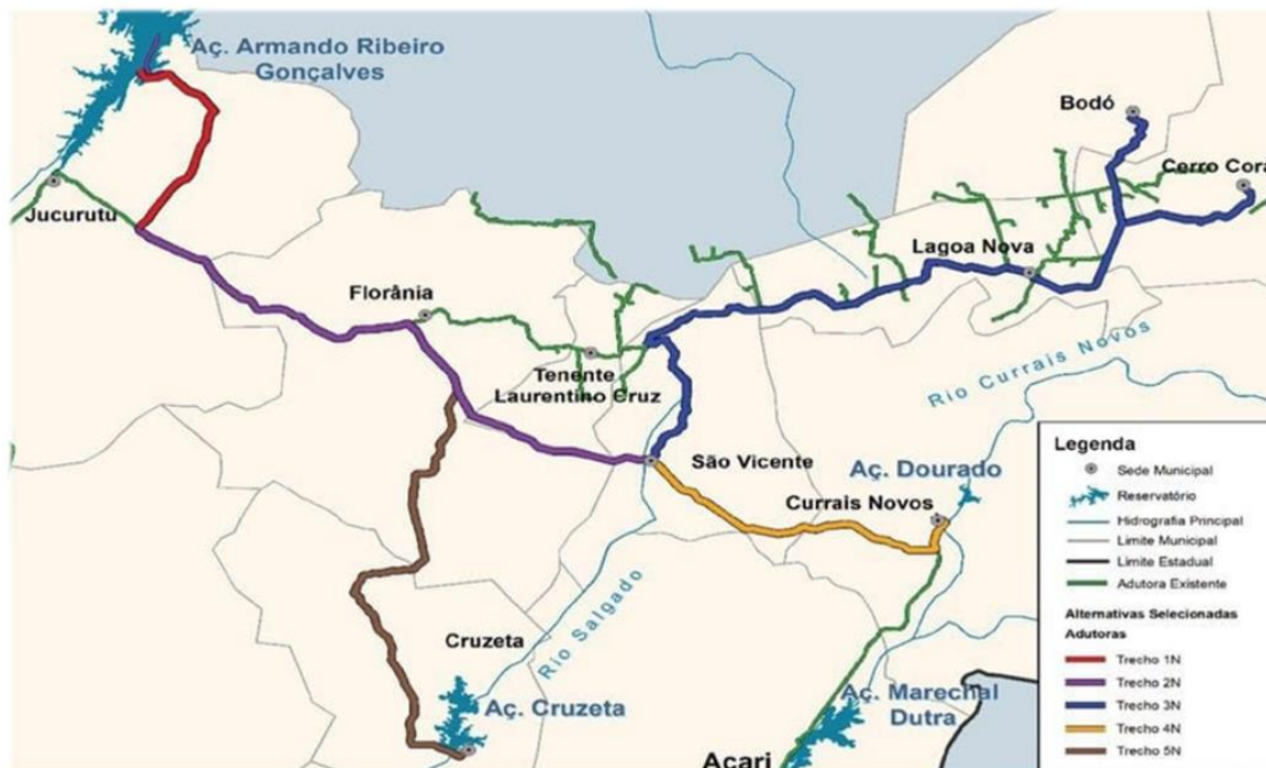
Figura 6 – Representação da rede de adutoras a serem construídas no âmbito do Projeto Seridó
