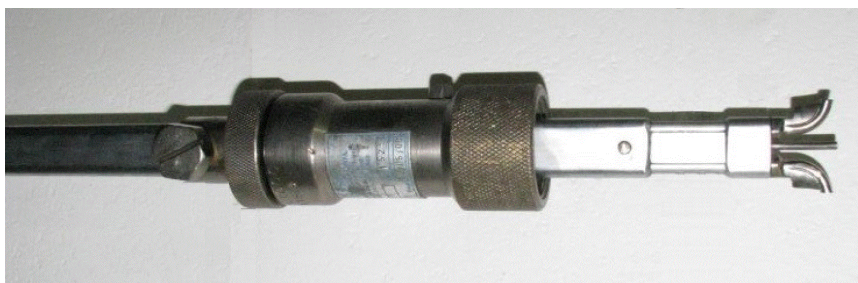
Figura 14. Tubo de Pitot do tipo Cole especial com um pino de segurança entre os tips .
