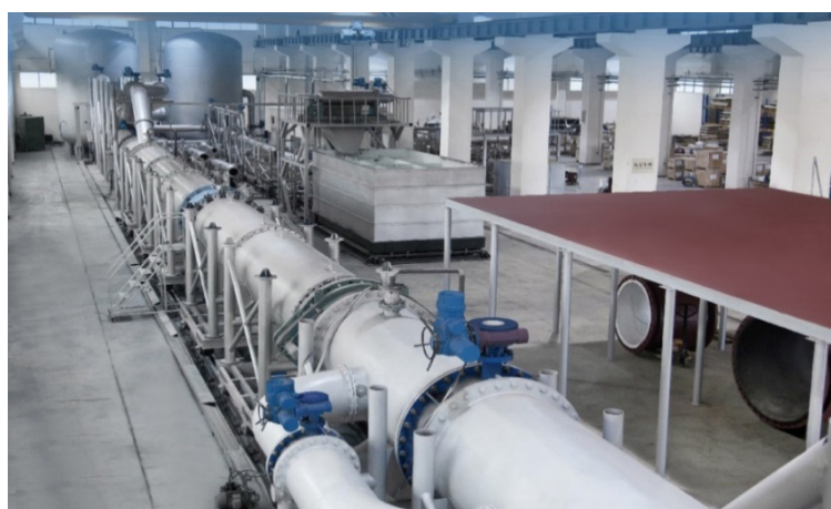
Figura 5. Calibração de macromedidor de água em laboratório de vazão.
