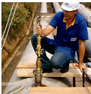
Figura 27. Exemplo de tap instalado e inserção de tubo de Pitot.
