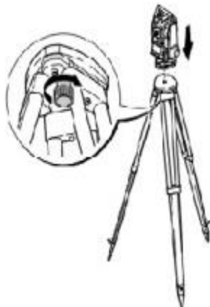
Figura 10 - Fixação da Estação Total no Tripé
