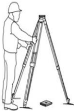
Figura 9 - Instalação do tripé
