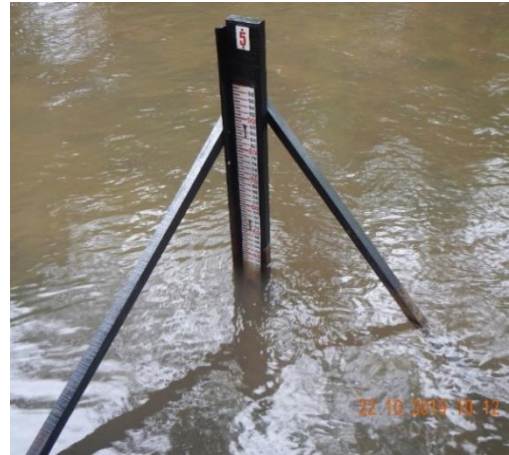
Figura 9 - Mourão de fixação em perfil metálico
