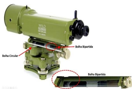
Figura 18 – Nível topográfico com bolha bipartida
