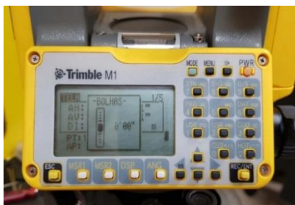
Figura 14 - Nivelamento da bolha tubular
