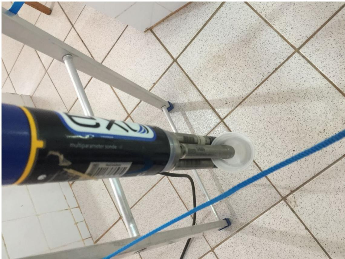
Após dado inicio no sistema de calibração, e escolhido o método de pontos onde sempre colocamos para iniciar com pH 7,00 e depois pH 4,00 na sequência, finalizando com pH 10,00.
