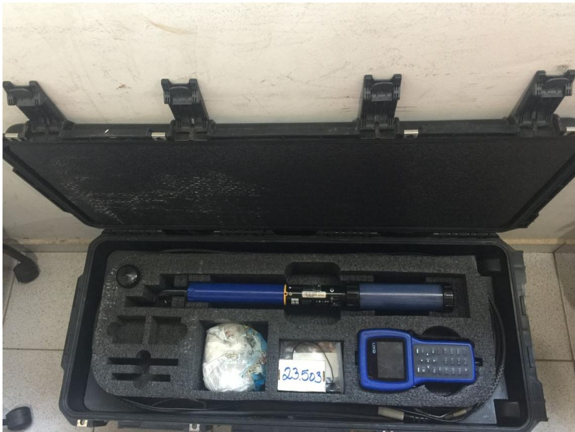
Depois de realizada limpeza e manutenção da sonda, ao fim da campanha, deve-se armazenar a sonda e os seus componentes, lembrando de retirar as pilhas e não guardar as mesmas com a sonda, os cabos devem ser limpos.
