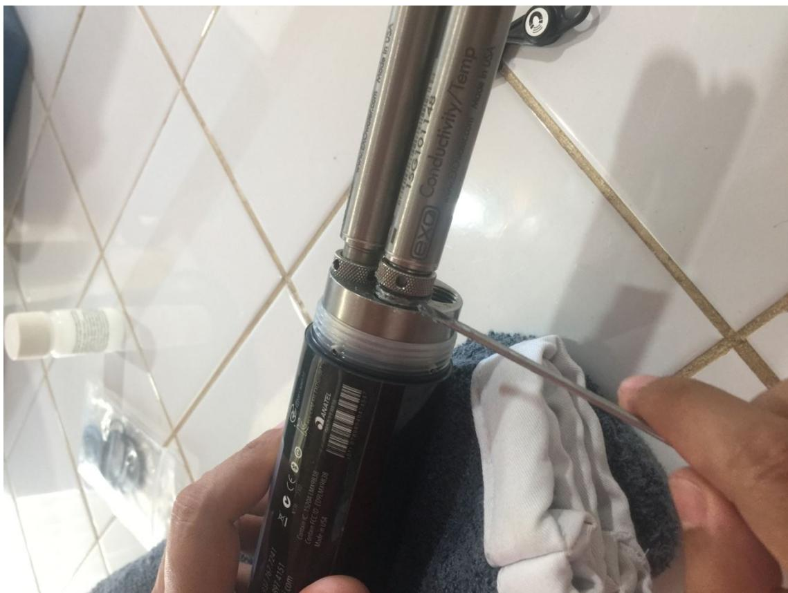
A mesma lubrificação é colocada nas partes rosqueáveis não só da sonda, mas como dos sensores. Após lubrificação, inserir os sensores que vão ficar armazenados com a sonda (OD sendo hidratado, turbidez, condutividade e temperatura).
