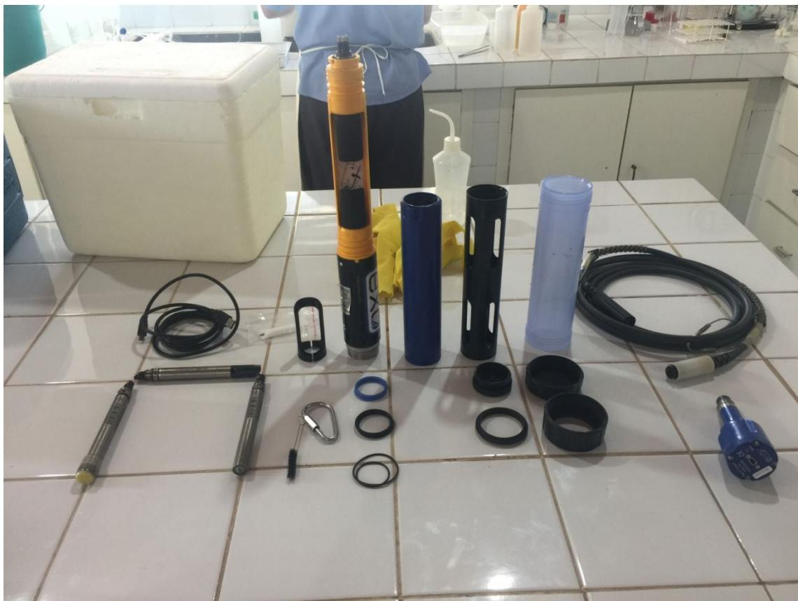
Após limpar a sonda para remover impurezas e acúmulos, deve-se montar a mesma de forma correta para seu armazenamento.
