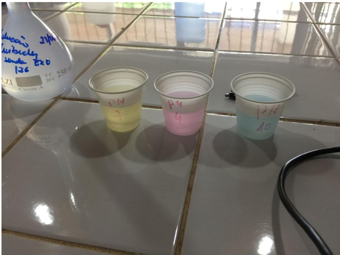
Primeiro, após deixar os reagentes de calibração fora da geladeira, em temperatura ambiente, por 24 horas, deve-se se colocar as soluções em recipientes identificados e na ordem de calibração, lembrando de verificar as condições do recipiente para não haver contaminação.
