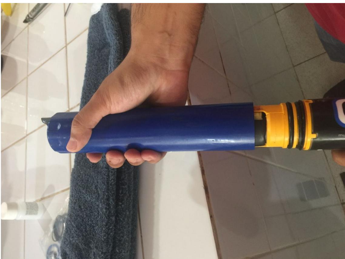
Feita as devidas verificações, colocar a cobertura da bateria. Realizar testes de rosqueamento para melhor encaixe e aderência das partes.
