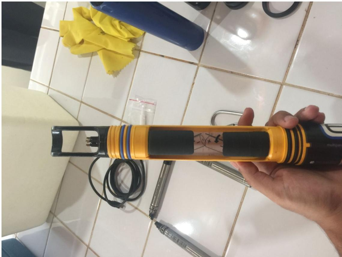
Primeiro, coloque os “orings”, lembrando de lubrificar os mesmos e os vãos destes.
