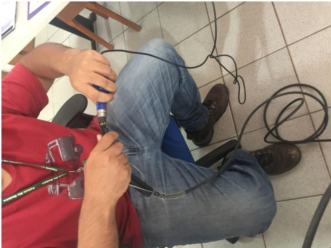
Conectar a outra ponta (macho) ao adaptador de USB SOA, lembrando de verificar possíveis impurezas e detritos e lubrificar as partes emborrachadas dos pinos.
