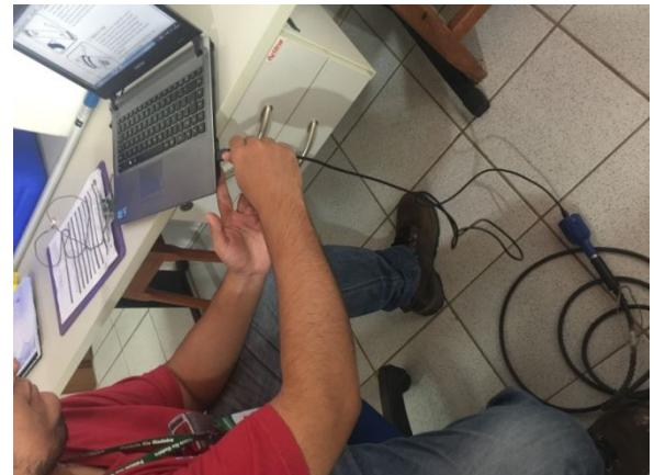
Conecar o cabo USB, removendo a proteção nas duas pontas, colocando a ponta no adaptador USB SOA, e a ponta USB no computador, na porta configurada para a conexão da sonda.
