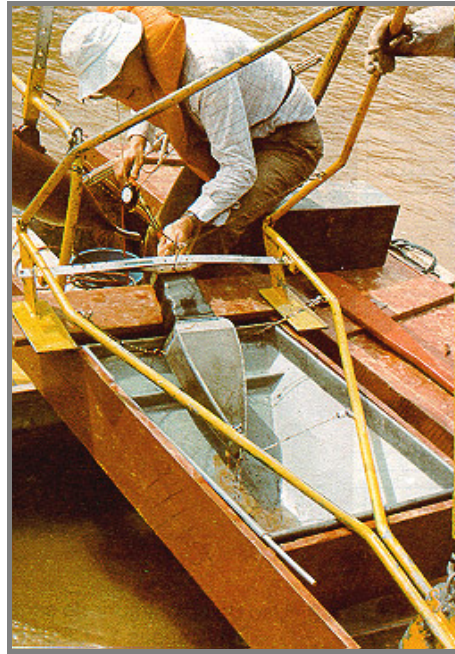
Figura 4.40 –Retirada da amostra na medição de descarga de arrasto com o amostrador Arnhem. Rio Coxim, MS – IPH/UFRGS (02.03.1994).
