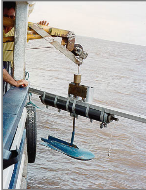
Figura 4.16 – Coletor de amostra d'água (Projeto Hibam)
