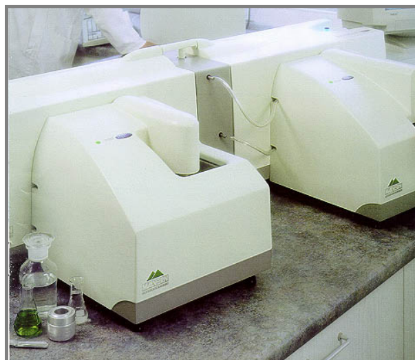
Figura 4.28 – O Mastersizer, que permite análise granulométrica de sedimento com pequena quantidade de amostra.
