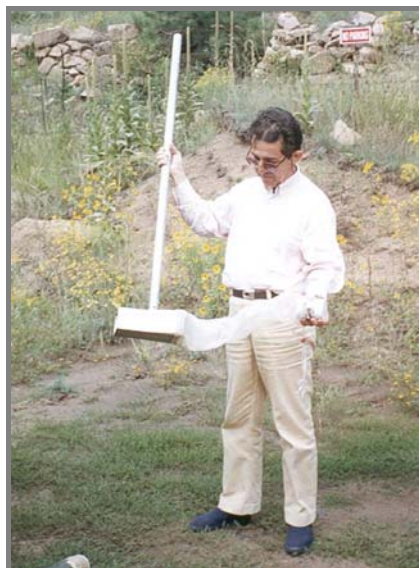
Figura 4.27 – Amostrador BLM-84 para medição a vau de carga sólida do leito (Rickly Hydrological, 1999).
