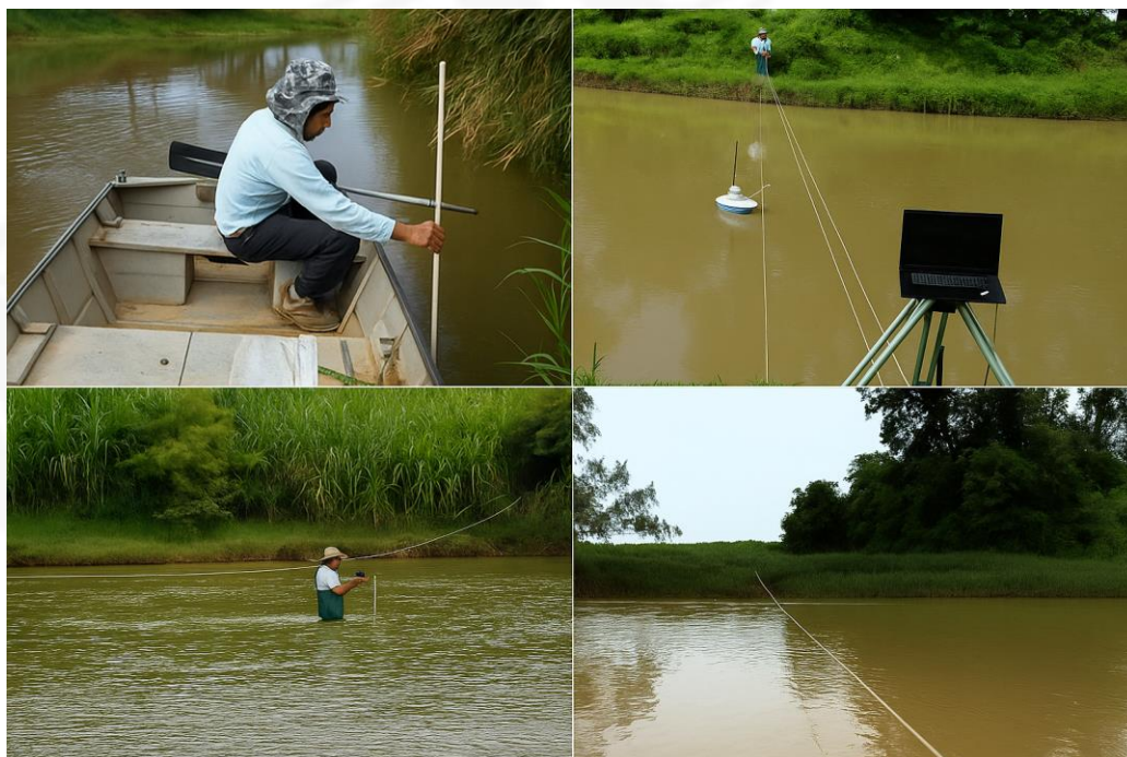
Figura 19 – Exemplos de uma sessão de medição de descarga líquida com molinete e medidor acústico
