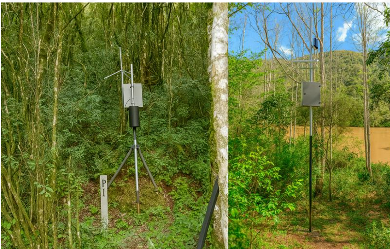
Figura 7 – Instalação de PCD em local inadequado próxima a vegetação
