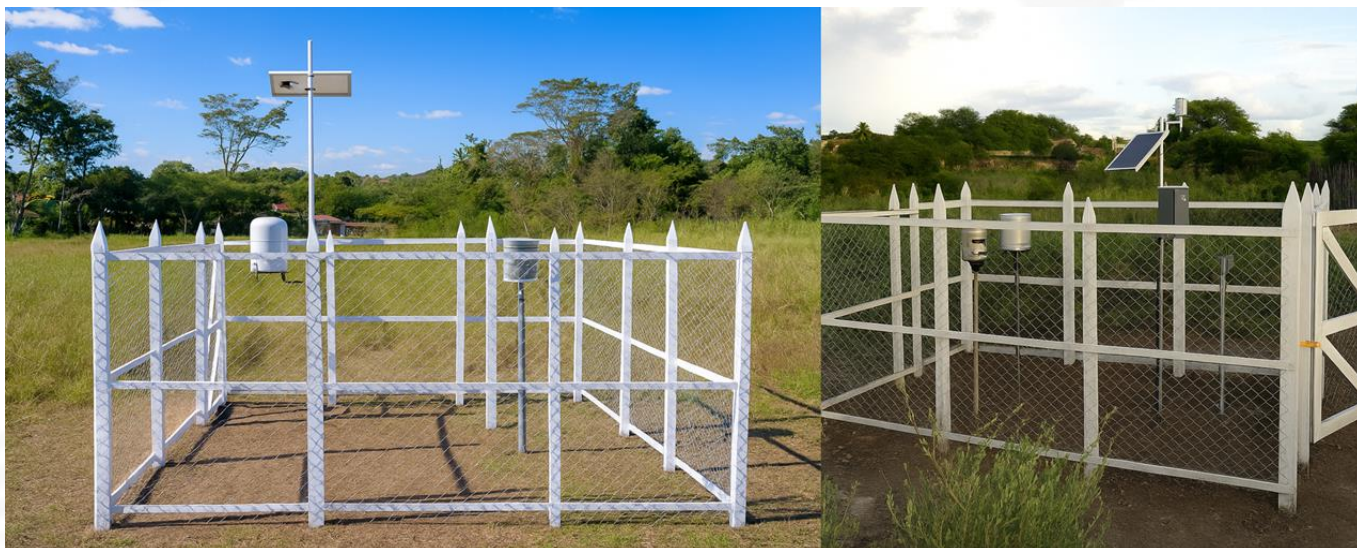
Figura 6 – Exemplo de instalação correta de estações pluviométricas automáticas
