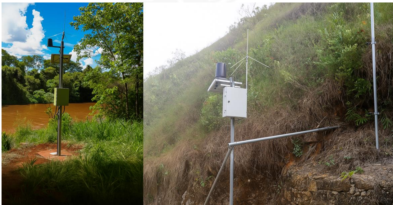
Figura 8 – Pluviômetros instalados em altura irregular, com vegetação nas cercanias, sem cercado de proteção, em local de possível inundação e instável
