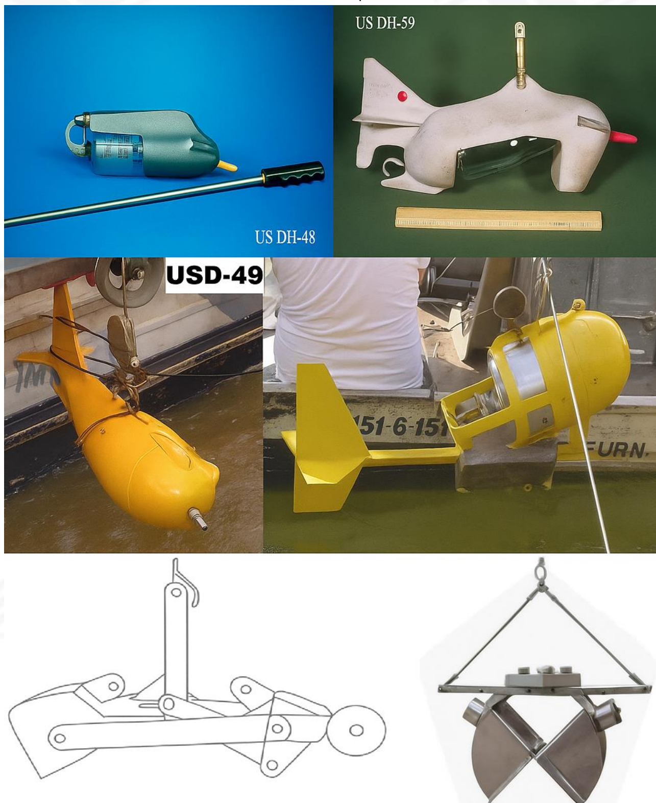
Figura 20 – Exemplos de amostragem de sedimento em suspensão (US DH-48, US DH-59, USD-49, AMS8) e de fundo tipo Peterson
