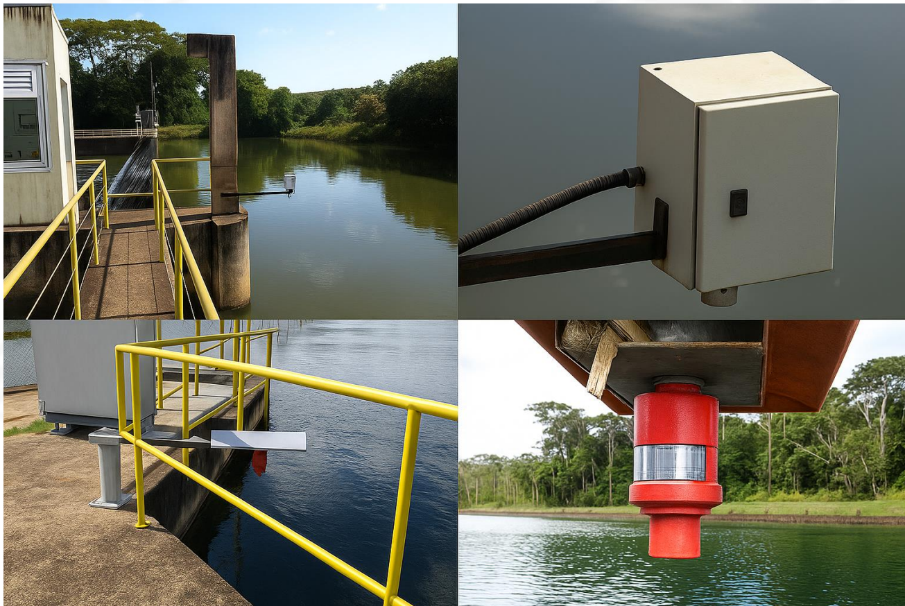
Figura 27 - Detalhe da instalação do sensor eletromagnético em barramento em suporte metálico
