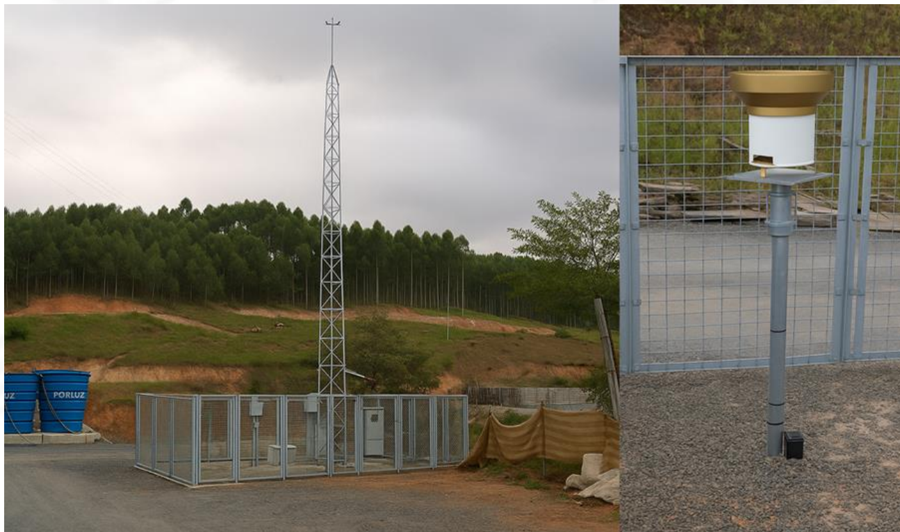
Figura 4 – Foto para demonstração da exposição do pluviômetro
