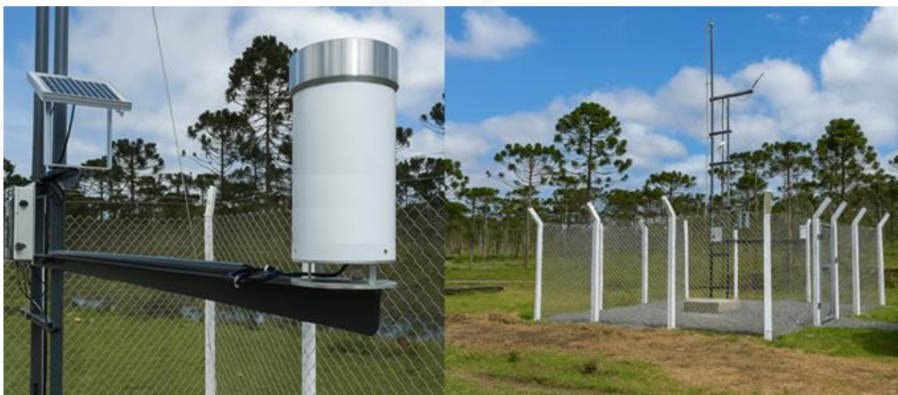
Figura 5 – Foto do local onde encontra-se instalado o pluviômetro e detalhe do equipamento instalado
