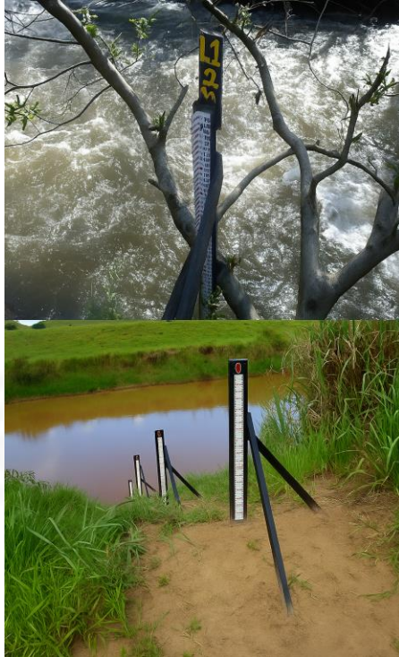
Figura 17 – Réguas limnimétricas instaladas em mourões fora do padrão definido pela ANA
