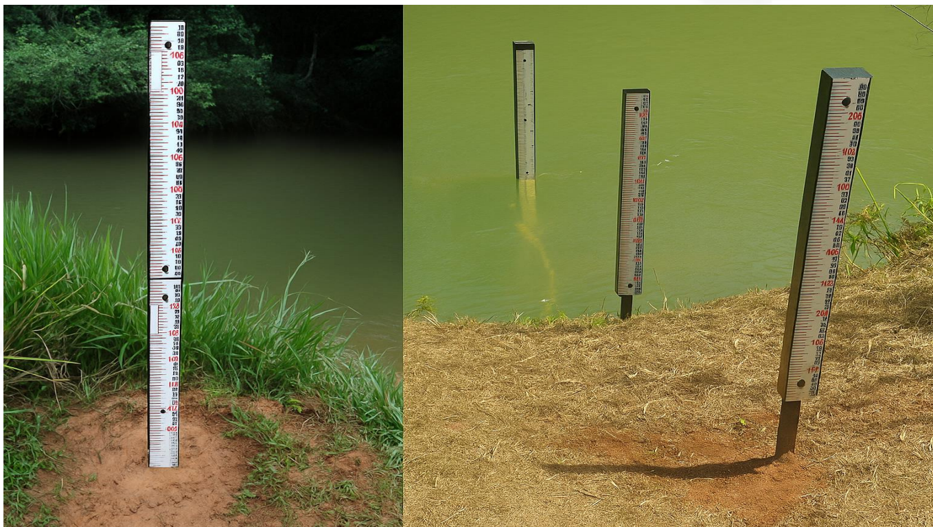
Figura 16 – Régua limnimétrica instaladas em mourões fora do padrão definido pela ANA
