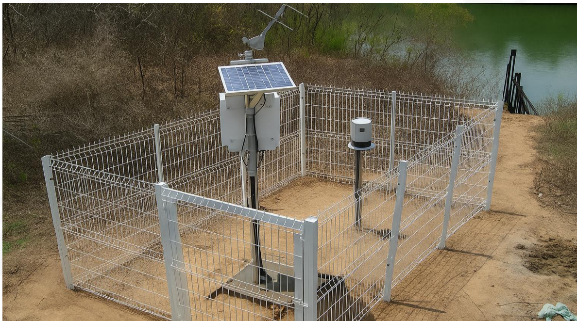
Figura 22 – Pluviômetro Automático instalado dentro de um cercado metálico
