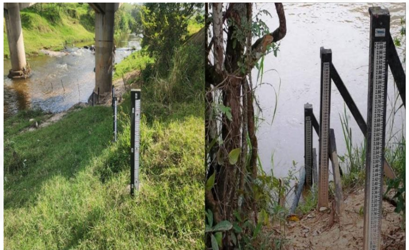
Figura 13 - Exemplo de seções de réguas instaladas segundo os padrões da ANA
