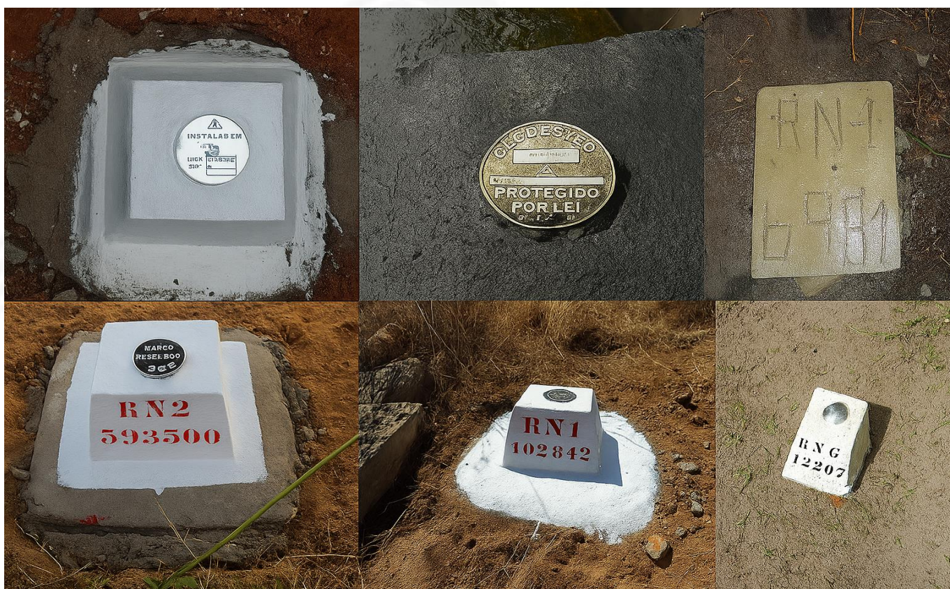
Figura 9 – Exemplo de RN's instaladas segundo os padrões definidos pela ANA
