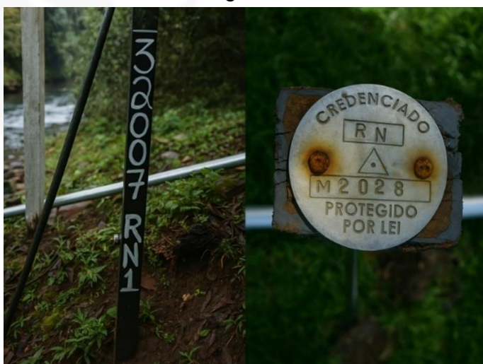
Figura 10 – Exemplo de RRNN instaladas que não devem ser seguidos
