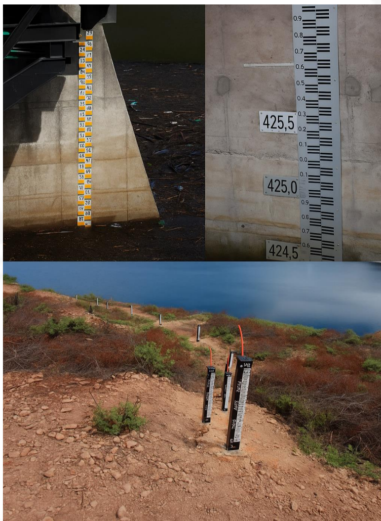
Figura 14 - Exemplos de réguas limnimétricas instaladas no barramento
