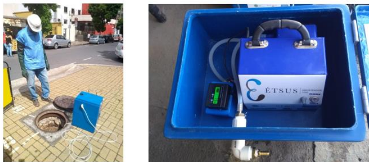
Figura 2: Amostragem sendo realizada em um dos pontos de monitoramento. Detalhe para a parte interna do amostrador automático de líquidos Etsus 1000.
