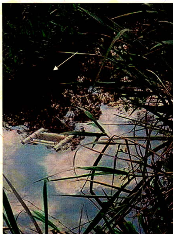
Figura 40. Substrato artificial do tipo flutuador, com lâminas de vidro: Detalhe do fio náilon de sustentação do flutuador (Foto: Rita Cerqueira Ribeiro de Souza)
