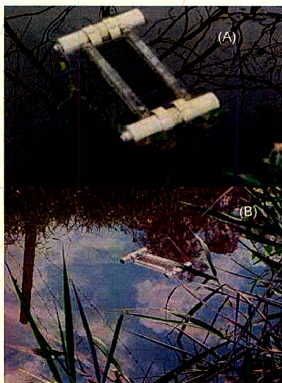
Figura 39. Substrato artificial do tipo flutuador, com lâminas de vidro: (A) Vista superior do flutuador; (B) Vista do flutuador instalado próximo à margem (Foto: Rita Cerqueira Ribeiro de Souza).
