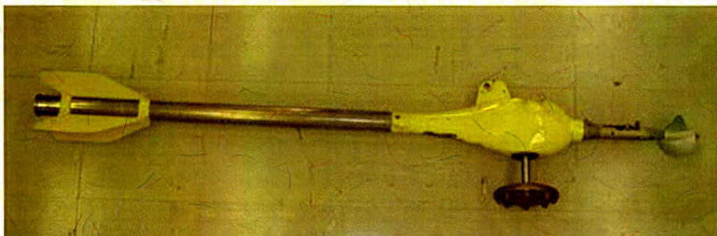
Figura 92. Molinete Hidrométrico (Foto: Luis Altivo Carvalho Alvim).
