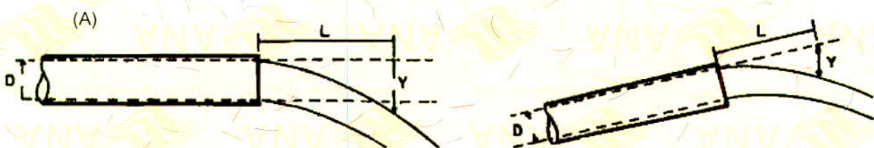
Figura 111. Método Califórnia Modificado: (A) Tubo horizontal; (B) Tubo inclinado (Fonte: CETESB, 1988).
