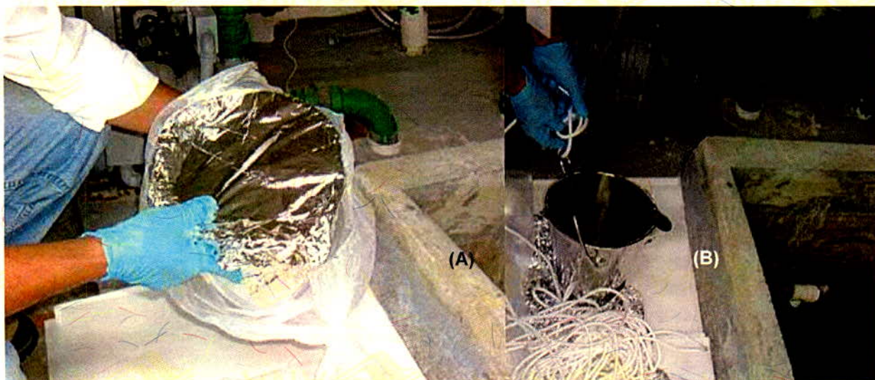
Figura 88. Coleta de amostras em reservatório com balde e corda estéreis: (A) Balde estéril, (B) Balde e corda estéril em procedimento de coleta (Foto: Venício Pedro Ribeiro).
