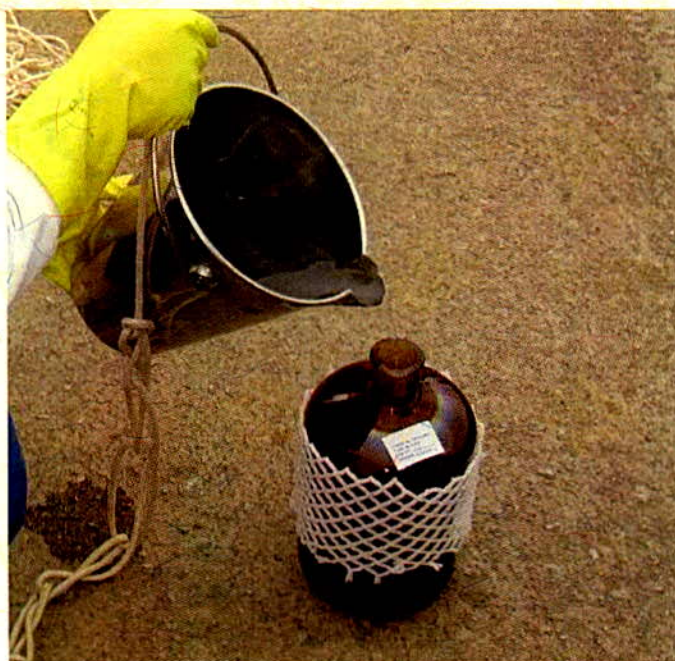
Figura 64. Coleta de amostra com balde de aço inox para Teste de Ames (Foto: Carlos Jesus Brandão).
