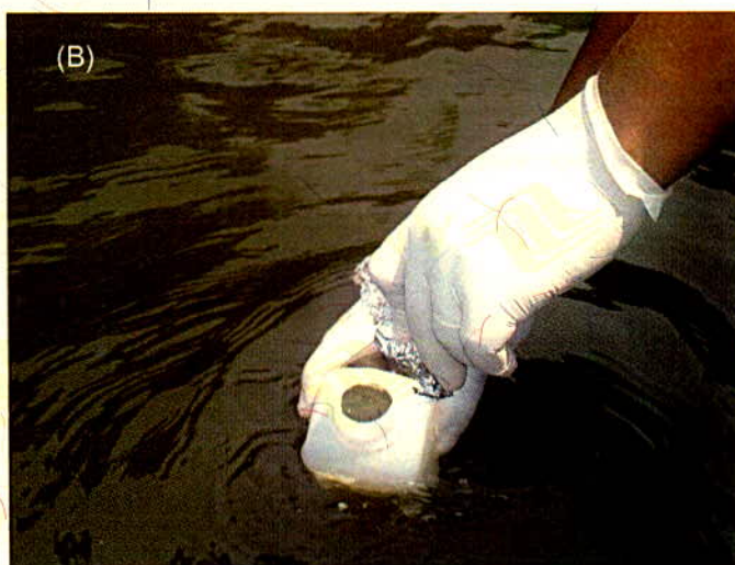
Figura 65. Coleta de amostra de água superficial para análise microbiológica: (A) com balde de aço inox; (B) diretamente do corpo d'água (Foto: Carlos Jesus Brandão).
