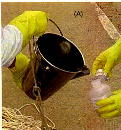
Figura 65. Coleta de amostra de água superficial para análise microbiológica: (A) com balde de aço inox; (B) diretamente do corpo d'água (Foto: Carlos Jesus Brandão).
