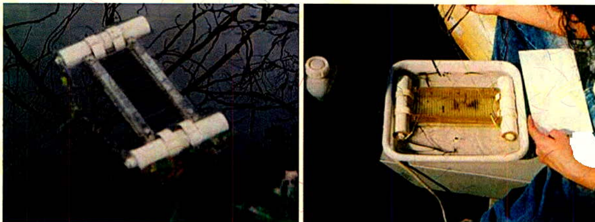
Figura 82. Coleta de amostras para Perifiton. (A) Flutuador de Lâminas de vidro; (B) Retirada do Flutuador de Lâminas de vidro (Fotos: Rita Cerqueira Ribeiro de Souza).
