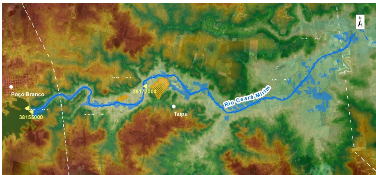
Figura 6 – Mancha de inundação no trecho a jusante com vazões sendo reduzidas desde 169\text{m}^3/\text{s} (na barragem) a 31\text{m}^3/\text{s} (divisa dos municípios Taipu/Ceará Mirim - RN)
