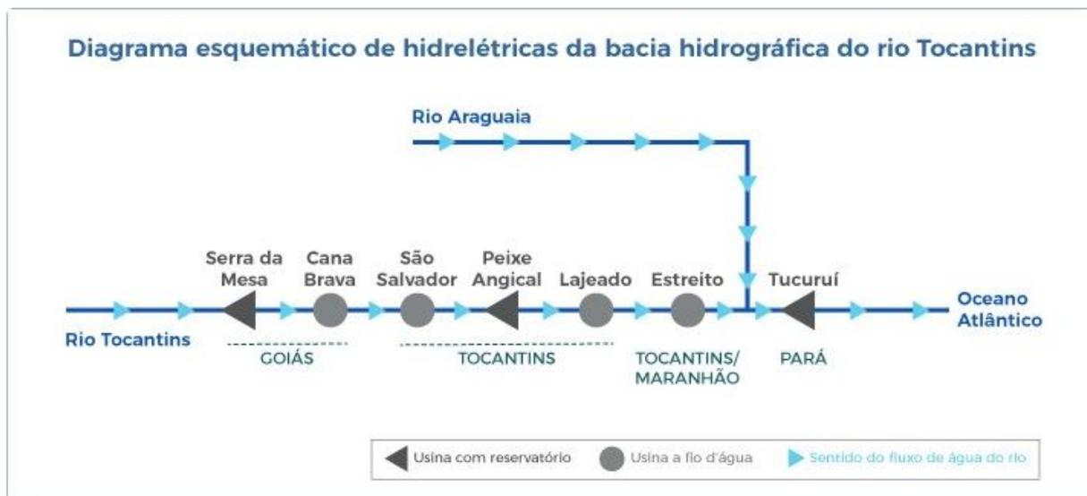
Figura 2 - Diagrama esquemático do rio Tocantins
