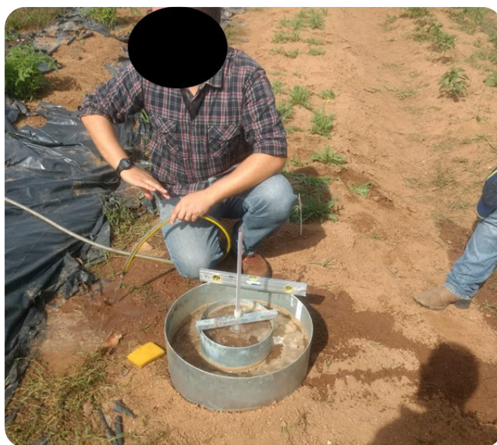
Foto 19 - Anel duplo instalado e preenchido com água, em Sorocaba (SP), 2018 Felipe Quartucci/Banco de Imagens ANA
