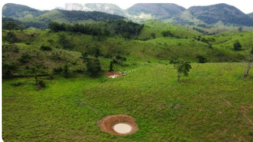
Foto 12 – Imagem demonstrativa de inserção de barraginhas em rota de enxurrada. Márcio Menon
