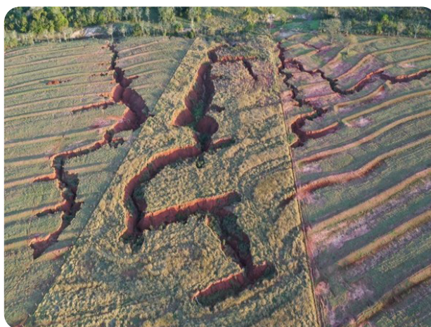
Foto 42 - Falha hidráulica sequencial causada por colapso de estruturas de terraceamento . Neste caso, o rompimento levou à destruição dos demais que estavam a jusante. Alexandre Puglisi Barbosa Franco
