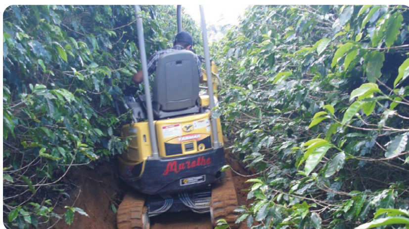
Foto 36 - Construção de microterraços em lavouras implantadas com Mini Escavadeira. KROHLING et al. (2023)
