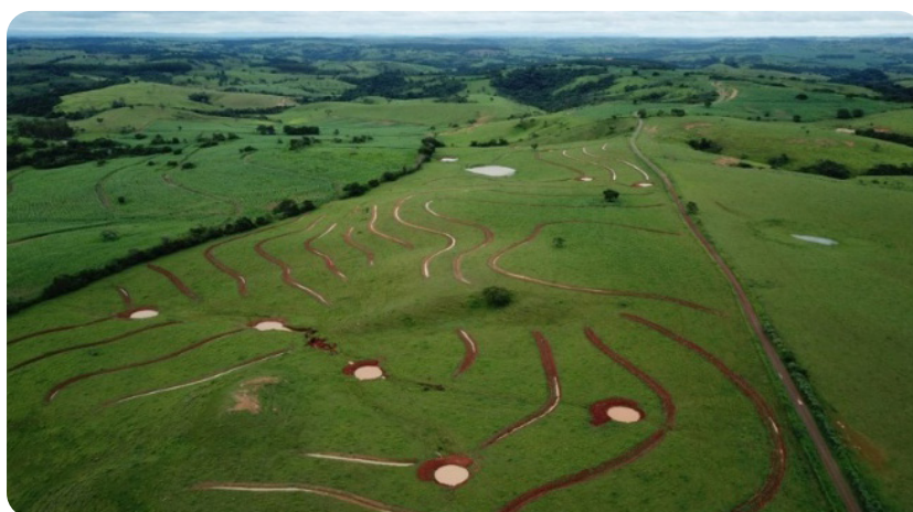
Foto 9 - Terraços e barraginhas em áreas de pastagem, Projeto Perobas - Produtor de Água. Dirceu de Oliveira Costa
