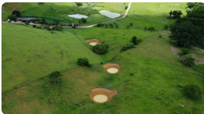
Foto 6 - Barraginhas em série no talvegue de uma drenagem natural do terreno Lucyan V. Listo/Projeto Barraginhas
