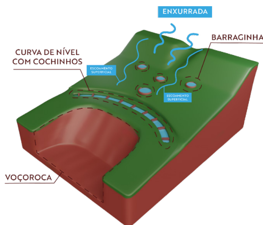
Figura 3 - Perfil esquemático de sistema de controle de voçorocas usando barraginhas e curvas de nível com cochinhos Fonte: Thiago José @tj.digital.art e Fernando Moura Antunes
