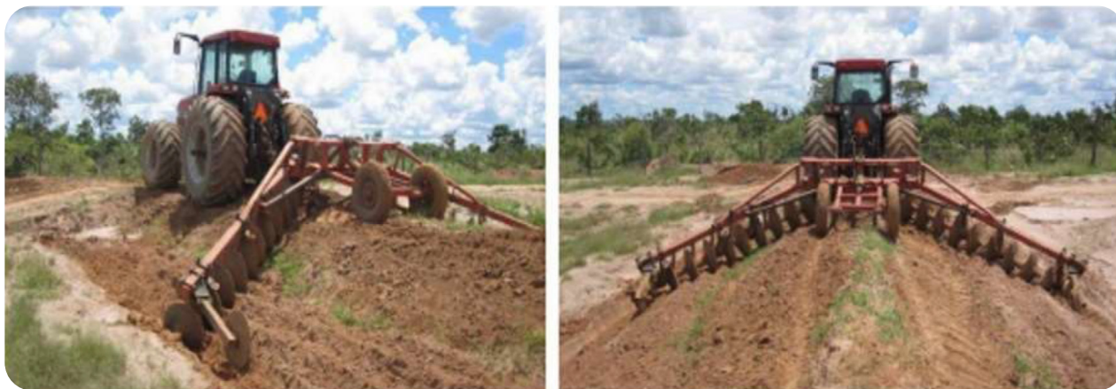
Foto 32 - Construção de terraço de base larga com arado terraceador agrícola. EMBRAPA, 2012.
