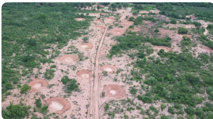
Foto 11 - Barraginhas recolhendo águas da estrada através de bigodes. Gustavo Mahé - Várzea da Palma/MG
