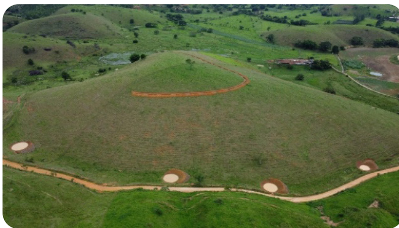
Foto 6 – Prática mecânica (barraginha) executada em estrada rural (ES) Marcio Menon / Banco de Imagens ANA
