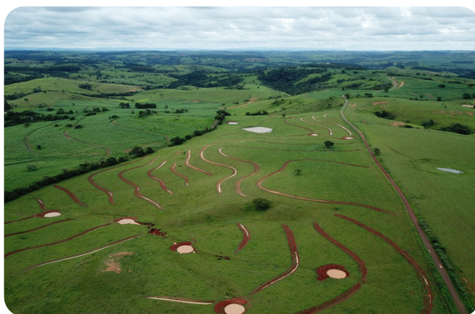
Foto 2 - Terraços e Barraginhas objetivando a coleta e infiltração da água, além da contenção de processos erosivos. Dorisópolis (MG) – Projeto Perobas – Produtor de Água Dirceu de Oliveira Costa/Banco de Imagens da ANA
