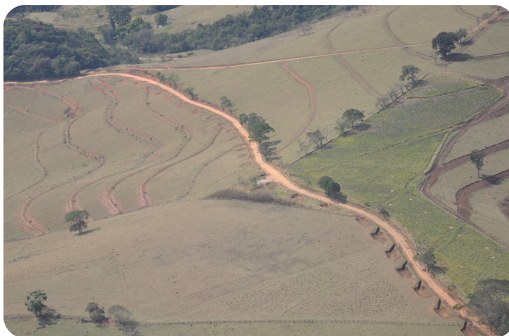
Foto 3 - Vista aérea uma área com curvas de nível, barraginhas, no município de Extrema (MG) Rossini Ferreira Matos Sena/Banco de Imagens da ANA
