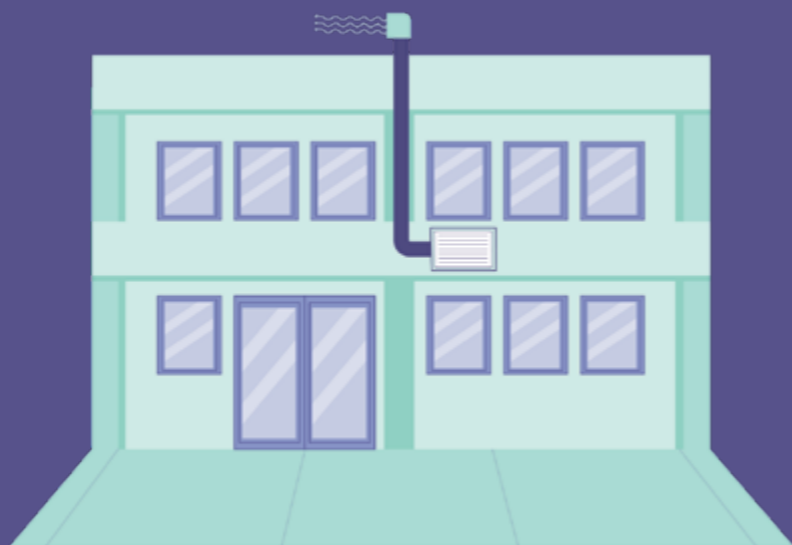
FIGURA 9 Duto direcionando fluxo de ar exaurido de isolamento respiratório
