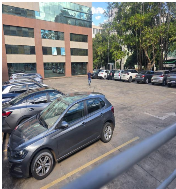
FOTO 5: Vagas externas a distância é superior à 50 m. Vaga sem sinalização vertical e sem rampa de acesso à calçada. Não há vagas acessíveis para visitantes externos. Não há vaga externa para idosos.
