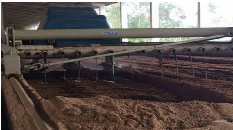
Processo de compostagem de efluentes da Granja Pizzatto.
