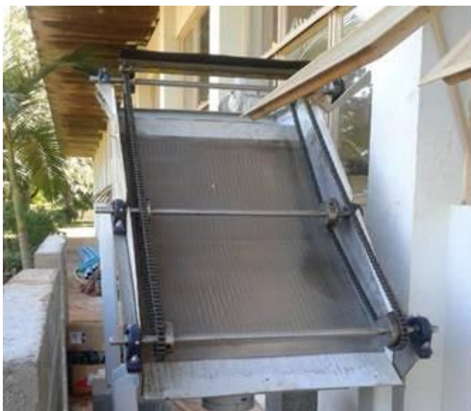
Peneira rotativa para retirada de 6% de sólidos do dejetos bruto
