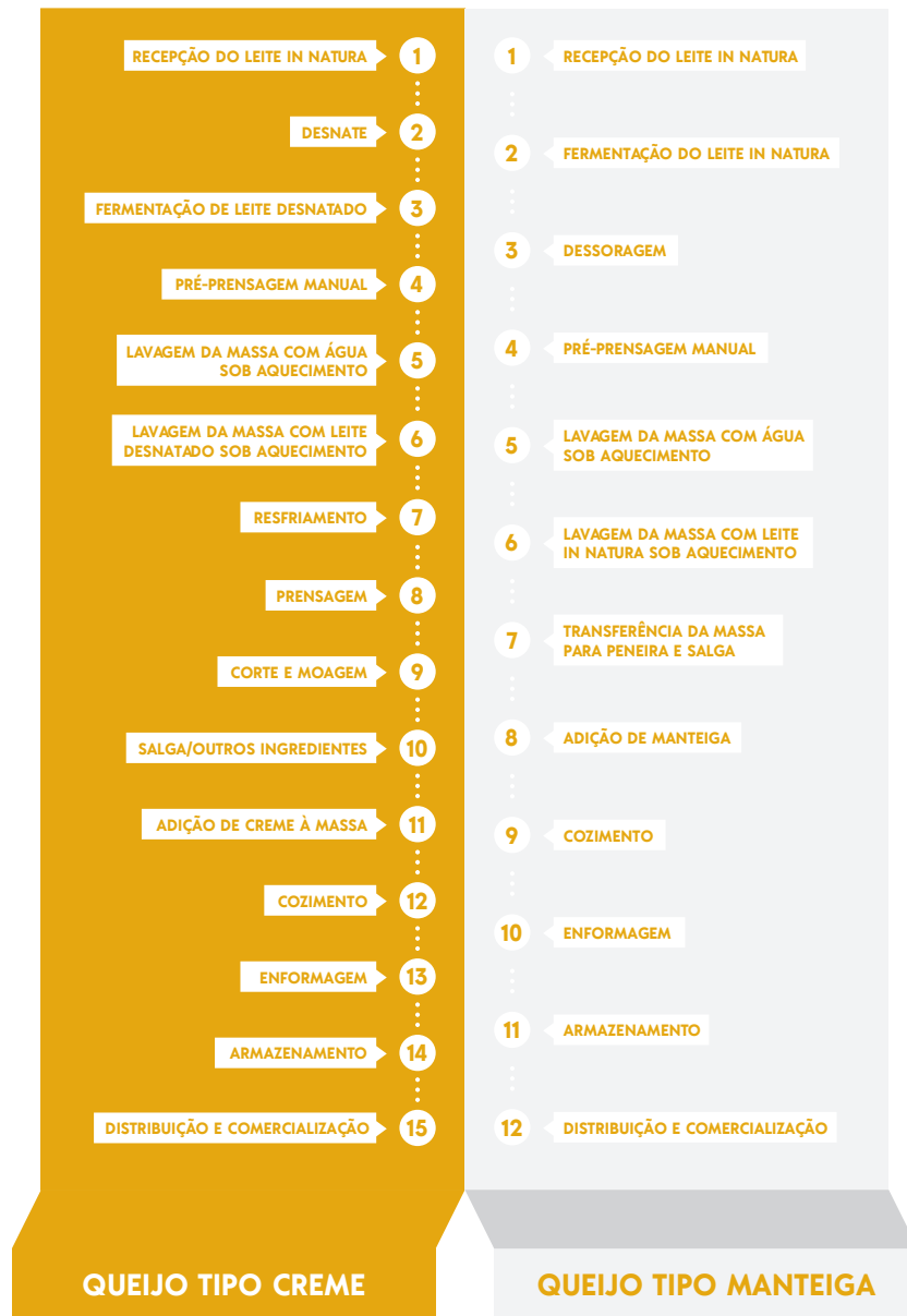
Figura 4. Fluxograma geral de fabricação dos queijos artesanais marajoaras.
