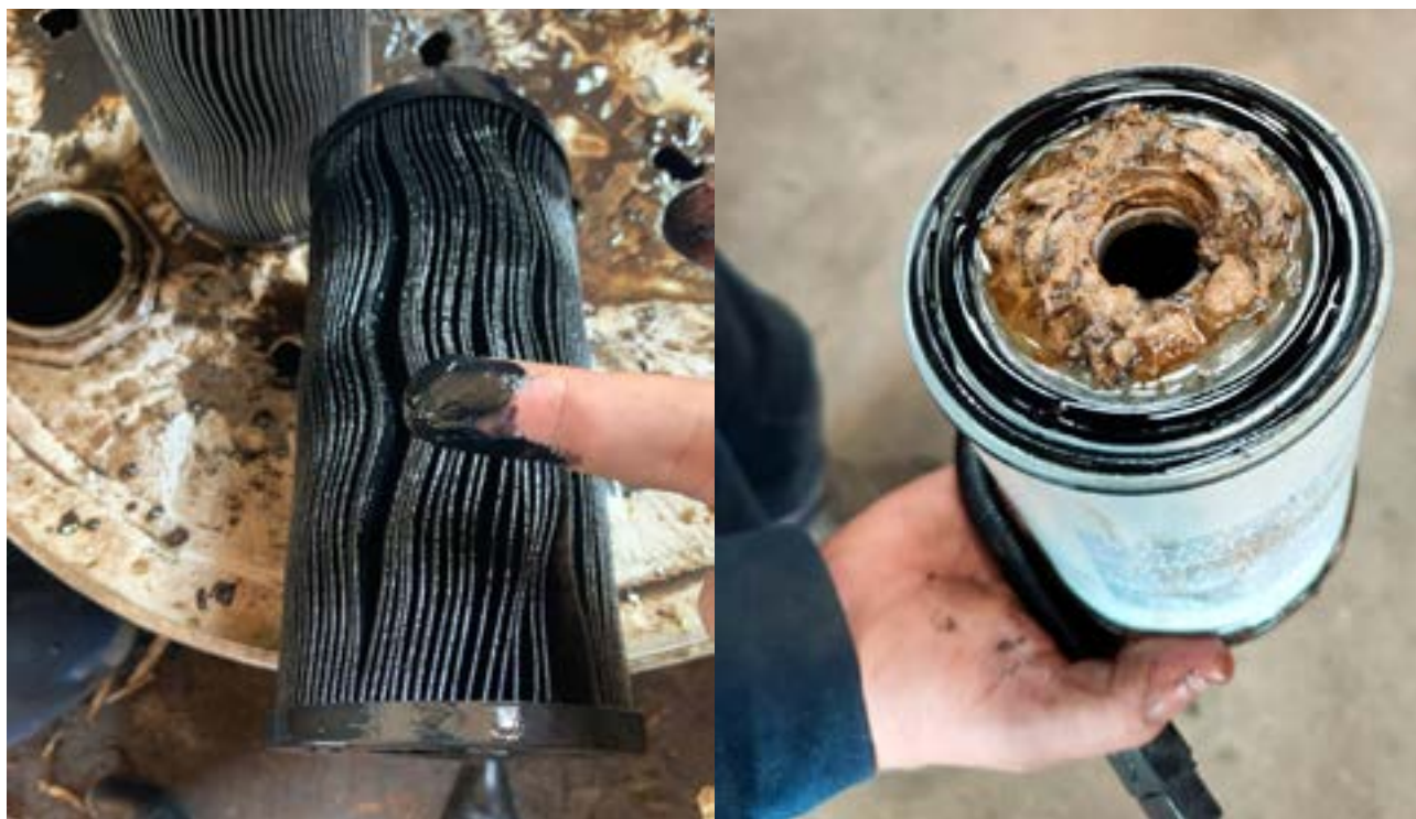
Figura 4 - Formação de depósitos biológicos e de produtos de envelhecimento do combustível dando aspecto “envernizado” ao componente
