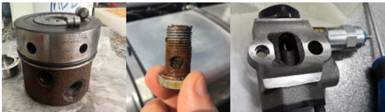
Figura 2 - Componentes do sistema de injeção após ação de água livre causando oxidação, desgaste e depósitos de lodo.
