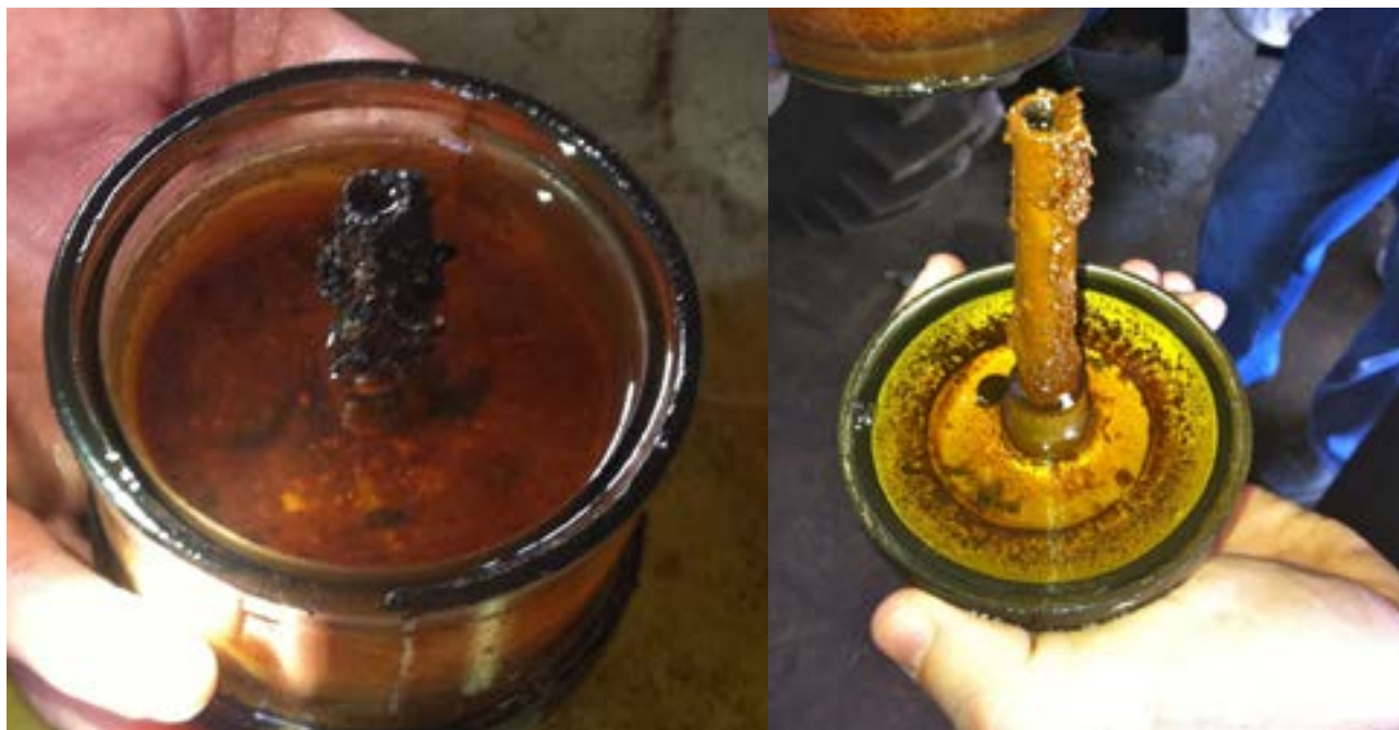
Figura 6 Aspecto de contaminação microbiana, identificada pela presença de material gelatinoso na interface óleo-água.
