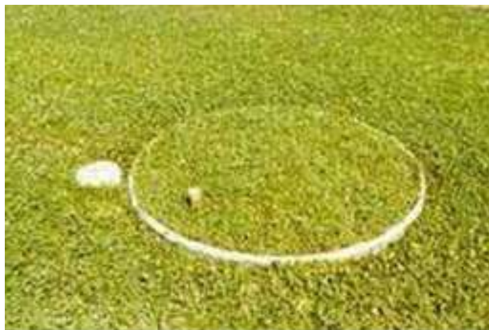
Figura 6. Lisímetro para medição da evapotranspiração de referência ou potencial Fonte: Collischonn; Tassi (2008)
