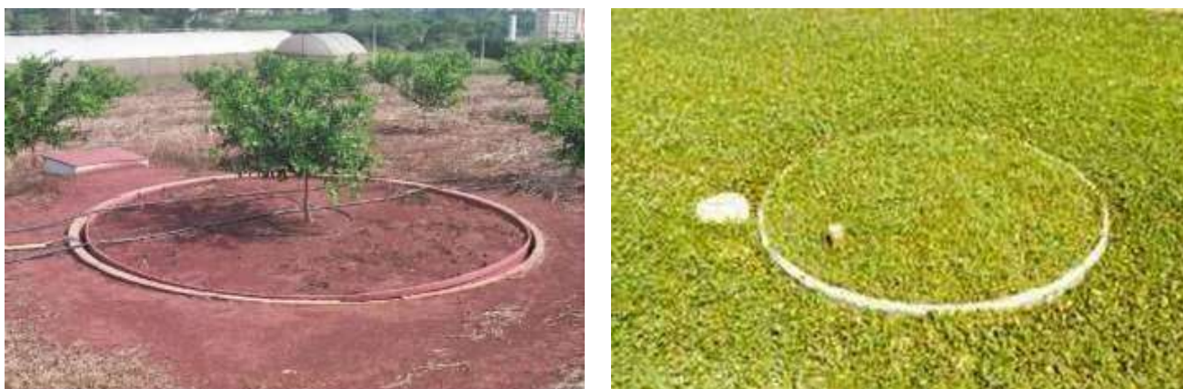
Figura 7. À esquerda, lisímetro para medição da evapotranspiração da cultura e, a direita, lisímetro para medição da evapotranspiração de referência ou potencial
