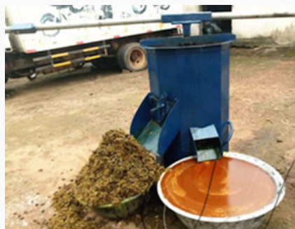
Figura 1: Extratora de óleo de palma usada por pequenos produtores
