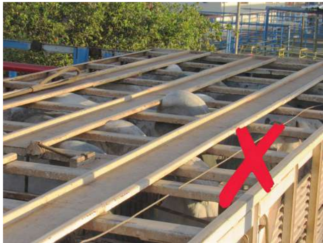
2. Cabeça, cupim ou dorso pressionado contra o teto ou ultrapassando as barras laterais ou transversais de proteção dos compartimentos de carga.
