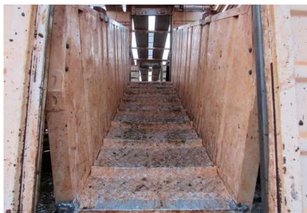
Rampa de acesso ao compartimento de carga com piso antiderrapante e laterais sólidas e resistentes.
