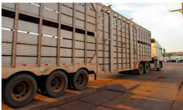
Compartimento de carga com aberturas nas laterais que permitem a ventilação e a inspeção dos bovinos.
