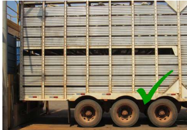
Veículo bem estacionado e alinhado corretamente, sem espaços, com a rampa de desembarque.
