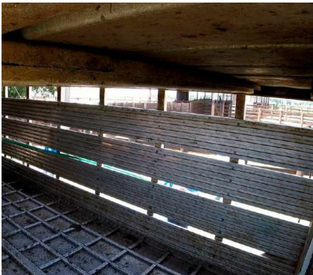
Parede lateral do compartimento de carga com frestas que permitem a circulação de ar, quando o veículo está em movimento.
