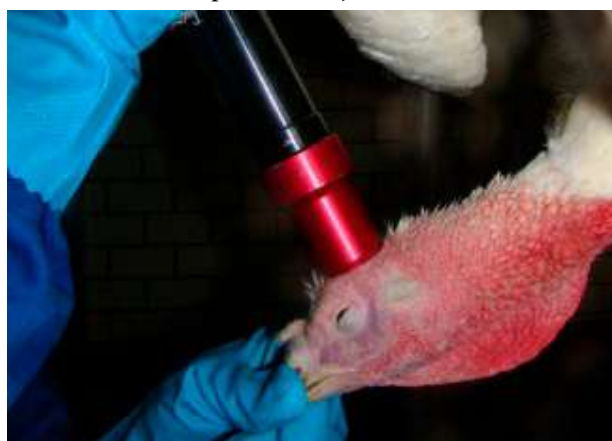
Insensibilizador mecânico individual – Pistola de dardo cativo.
