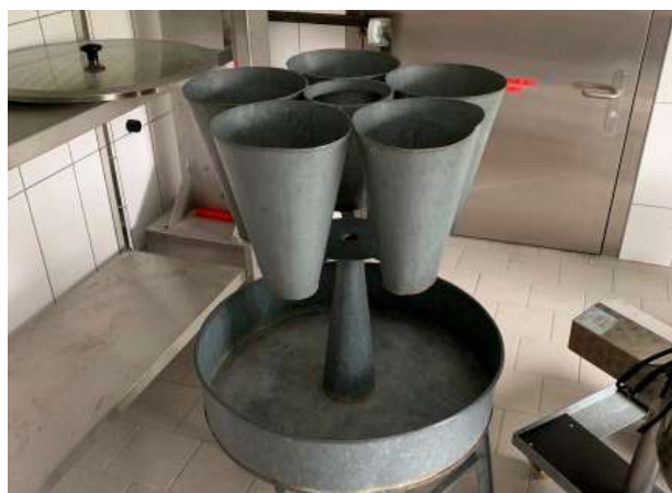
Estrutura de cones para contenção das aves.
