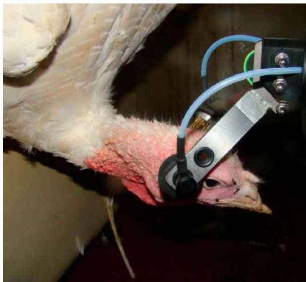
Insensibilizador elétrico individual.
