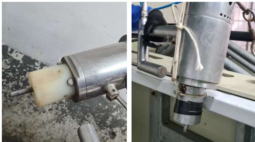
Pistolas de Dardo Cativo Penetrante acionada por ar comprimido (compressor), comumente chamada de pistola pneumática.
