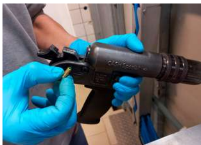
Pistolas de Dardo Cativo Penetrante acionada por cartucho de explosão (festim)
