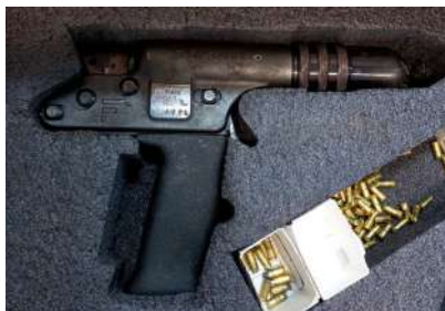
Pistola de dardo cativo (portátil) – atenção quanto aos cuidados no armazenamento dos cartuchos, e da pistola (local seguro e de fácil acesso).
