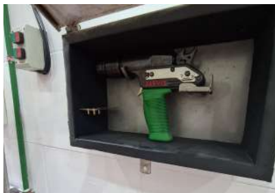
Pistola de dardo cativo (portátil) – atenção quanto aos cuidados no armazenamento dos cartuchos, e da pistola (local seguro e de fácil acesso).
