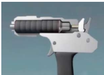
Pistolas de Dardo Cativo Penetrante acionada por cartucho de explosão (festim)
