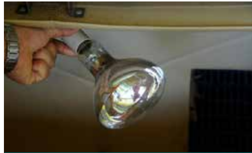
Figura 17. Dispositivo de aquecimento: lâmpada infravermelha
