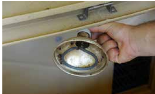
Figura 18. Dispositivo de aquecimento: resistência elétrica
