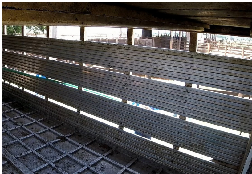
Parede lateral do compartimento de carga com frestas que permitem a circulação de ar, quando o veículo está em movimento (Fonte: BRAGA et al. 2020- Transporte Legal Bovinos) .
