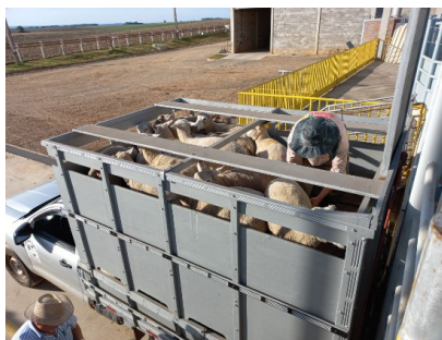
Tetos dos compartimentos de carga abertos, permitindo a circulação de ar, quando o veículo está em movimento.
