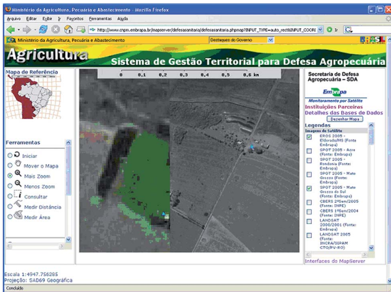
Fig. 2. Imagens dos satélites Spot (colorida) e Eros (monocromática), ilustrando a diferença de resolução espacial e o detalhamento de uma propriedade.
