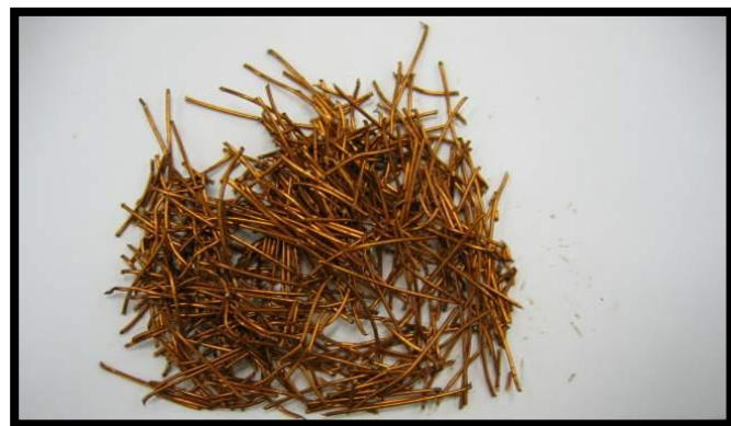
Cobre barnizado (el barniz detiene los ataques de H 2 SO 4 )
