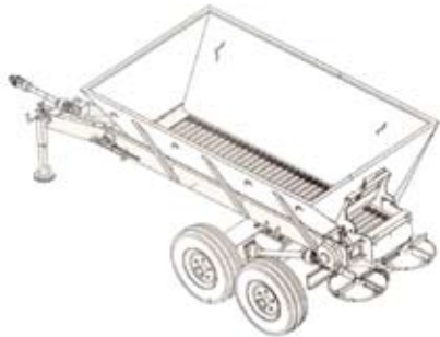
Figura 5. Máquina típica para a aplicação de sólidos, especialmente de calcário e gesso, com mecanismo dosador de esteira e mecanismo distribuidor centrífugo a lança, de dois discos.
