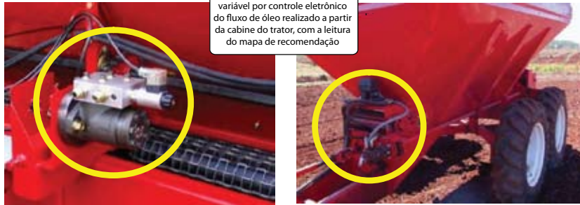
Figura 6. Exemplos de sistemas com motor hidráulico que aciona o dosador e regula a taxa de aplicação dos produtos pela máquina a partir de controle eletrônico e mapa de recomendação
