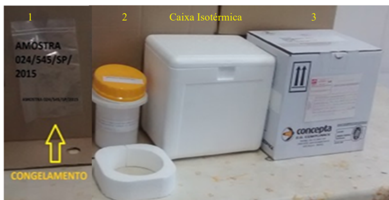
Foto 11 – Exemplo de Embalagem Tríplice: saco plástico de fechamento hermético (1- Embalagem Primária), frasco boca larga com fechamento hermético e resistente (2- Embalagem Secundária), isopor, que não é considerado embalagem porque permite troca de gases (caixa isotérmica) e caixa de papelão (3- Embalagem Terciária)
