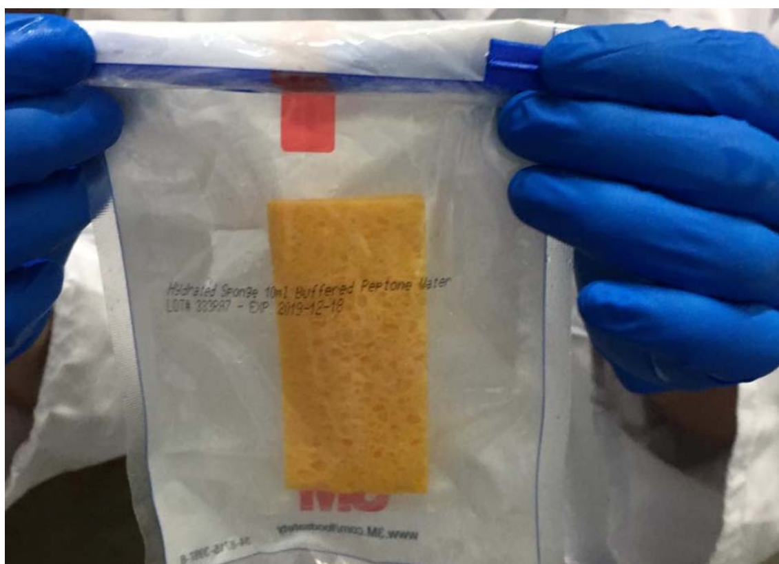
Figura 2.5.4 - Esponja de celulose pré-hidratada para coleta de amostra de esfregadura de superfícies em carcaça suína.
