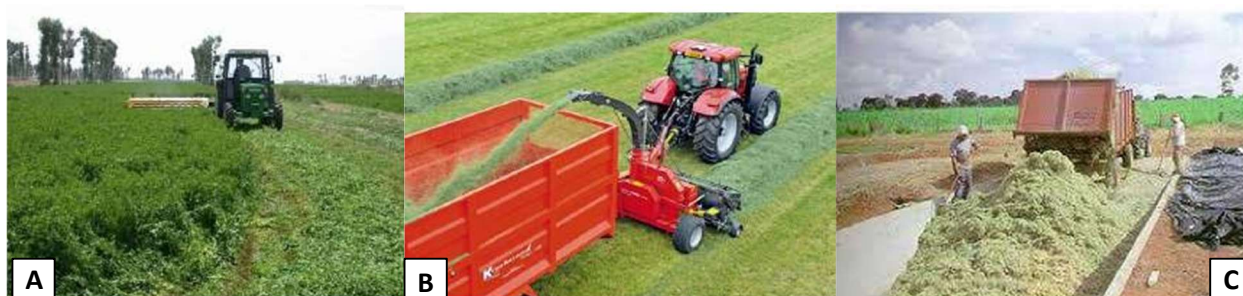
Figura 3. Corte (A), picado (B) y ensilado (C) de alfalfa
