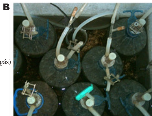
Figura 1. A. Representação esquemática do biodigestor (Adaptado de Robra, 2006). B. Biodigestor em escala laboratorial do Programa de Pós-graduação em Desenvolvimento Regional e Meio Ambiente da UESC.
