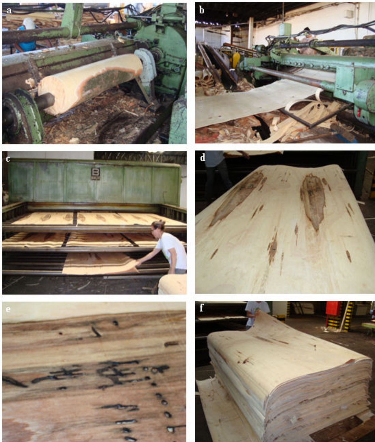
Figura 2 – Processo de laminação e secagem: a) torno laminador; b) manto de laminação; c) secagem de lâminas; d) defeitos de coloração e oxidação; e) defeitos devidos às ranhuras do painel de extração de látex; f) lâminas secas e classificadas.
