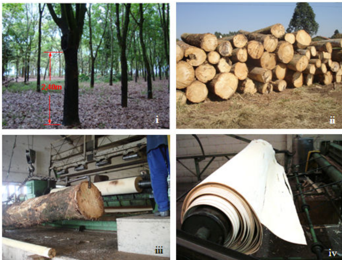
Figura 1- Plantio e etapas do processo de laminação: i) plantio de seringueira e comprimento das toras; ii) estoque de toras no pátio da indústria; iii) torno laminador; iv) manto de laminação bobinado.
