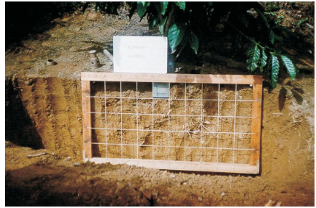
Figura 2 - Tela medindo 1,00 m X 0,50 m, com caixa metálica coletora incrustada em quadrícula de coleta (no detalhe).
