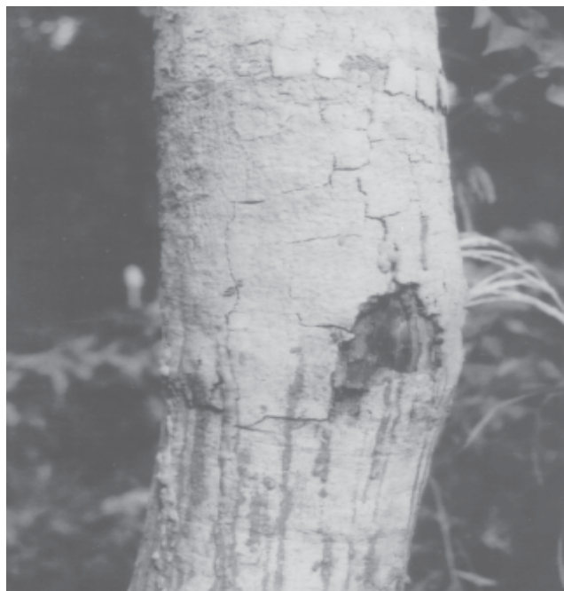
Figura 2. Desprendimento da casca da seringueira devido ao uso de sensor de fluxo de seiva do Método de Balanço de Calor modelo SGA 150 – WS (Dynamax Inc.), evidenciando o aparecimento de fungos oportunistas.
