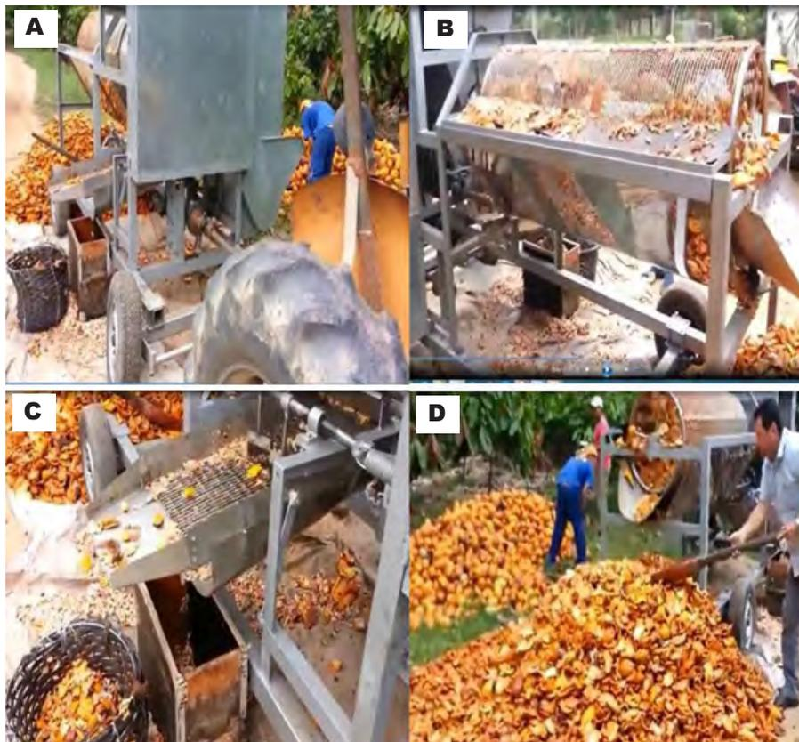
Figura 126. Máquina móvel de quebra de frutos de cacau. Vista lateral da máquina (A), cilindros e bandejas de separação de cascas e sementes (B e C); Manejo da casca após a quebra (D).
