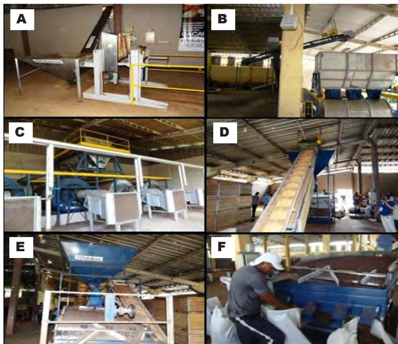
Figura 129 - Sistema de secagem de amêndoas. Esteira de transporte de amêndoas fermentadas (A e B); secadores rotativos (C); esteira para transporte de amêndoas secas (D), separador de impurezas (E); Ensacamento de amêndoas secas ( F).
