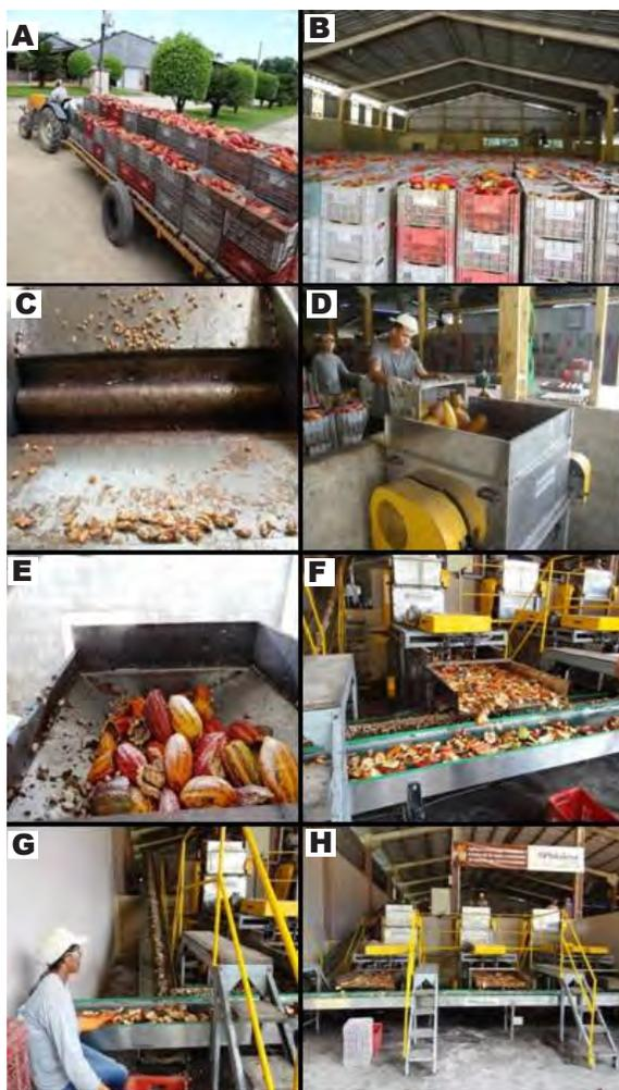
Figura 127- Sistema de quebra e extração de sementes em usina. Transporte e armazenamento de frutos (A e B), detalhe do cilindro de quebra (C), alimentação do sistema de quebra (D e E); sistema de separação de sementes e cascas (F e G). Vista frontal do sistema de quebra em usina (H).
