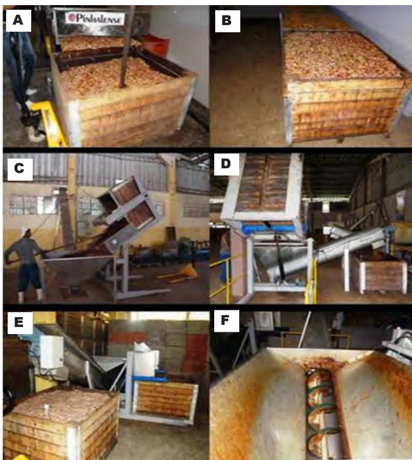
Figura 128 - Sistema de fermentação com movimentação mecanizada. Cochos de fermentação (A e B); Revolvimento das amêndoas entre cochos de fermentação (C, D e E). Detalhe da rosca sem fim para transferências de amêndoas entre cochos(F).
