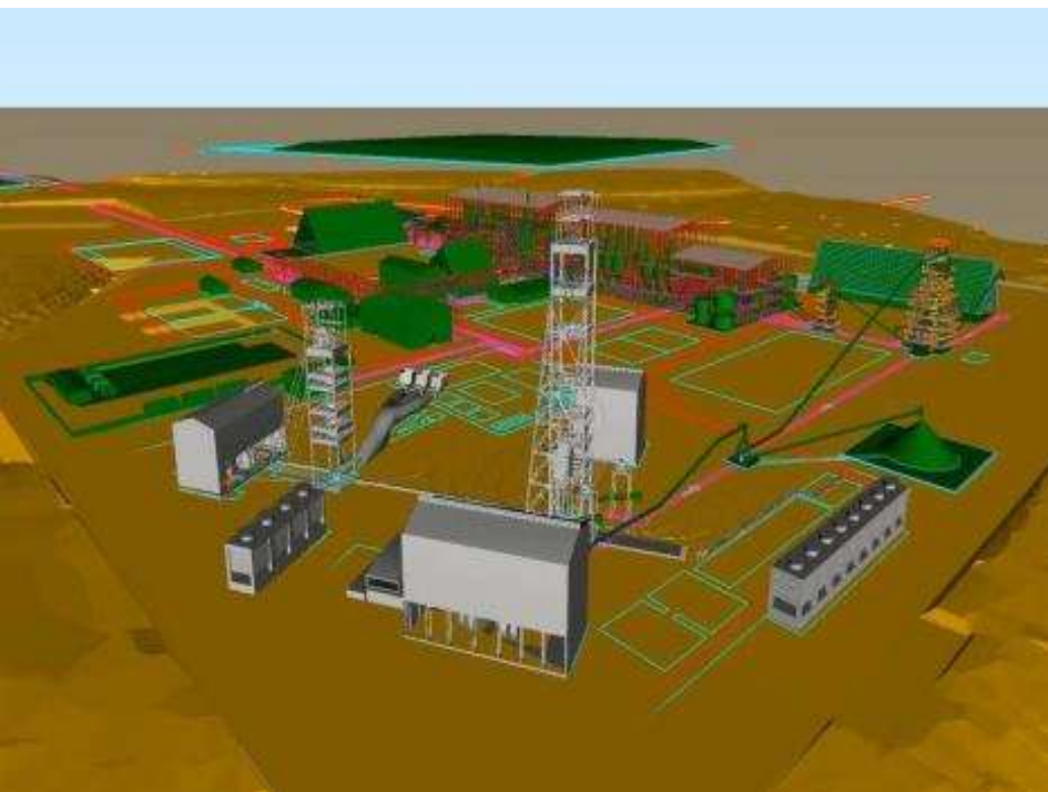
Mina: Subterrânea com 8,5 Mtpa ROM Usina: Produção de 2,4 Mtpa Potássio Granulado
