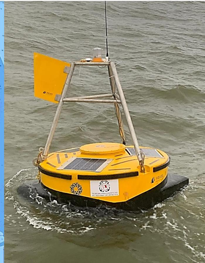
*Em março, foi fundeada a primeira das três boias meteoceanográficas do sistema de calado dinâmico da barra norte do Rio Amazonas. Sensores dos equipamentos fornecem dados de correntes, altura de maré e densidade da água, durante todos os dias da semana*
