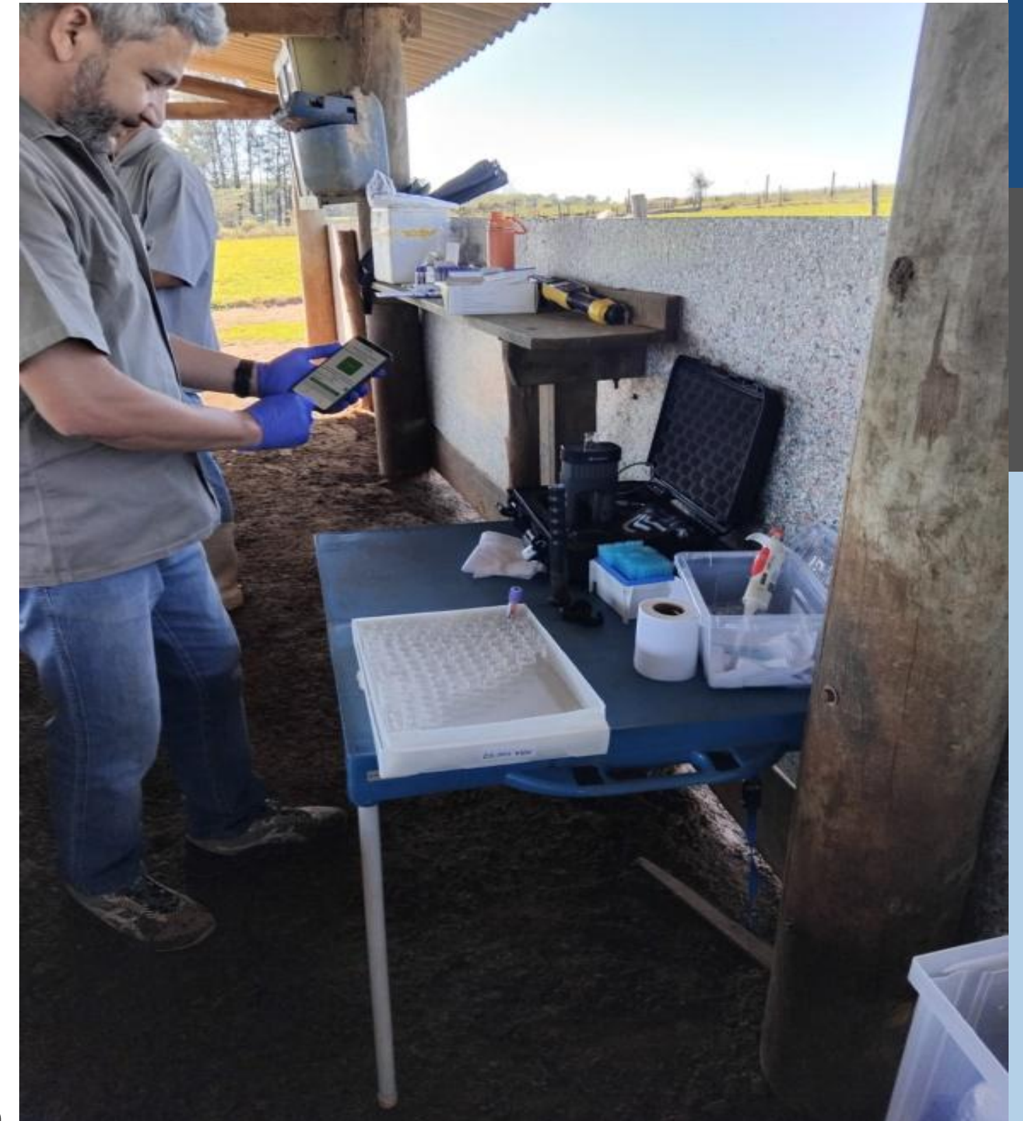
Figura. Coleta de espectros em sangue de ovinos a campo utilizando NIR portátil.
