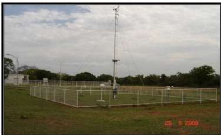
Figura 47: Estação Automática de Superfície instalada e em operação em Brasília - Campus do INMET. Instalada em Junho/06.
