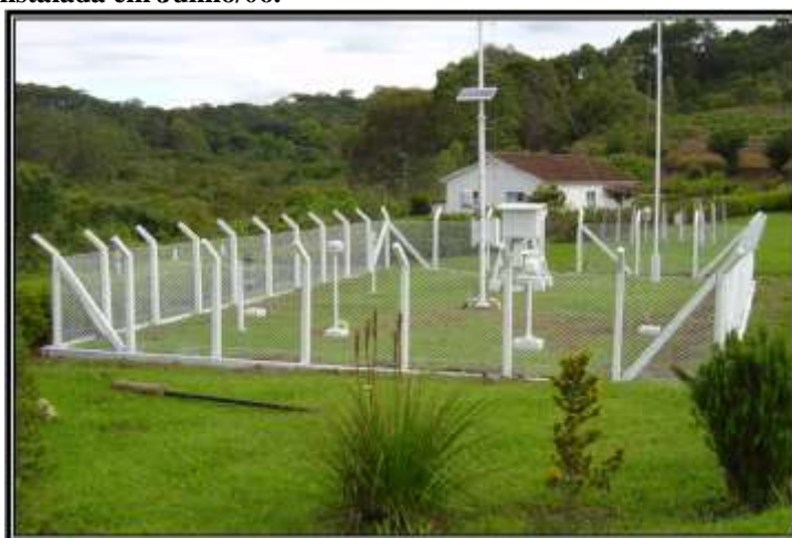
Figura 48: Estação Automática de Superfície Instalada e em operação ESMET Maria da Fé – MG
