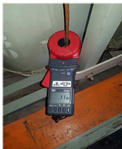
MEDIÇÃO DA MALHA DE ATERramento DOS TRANSFORMADORES
