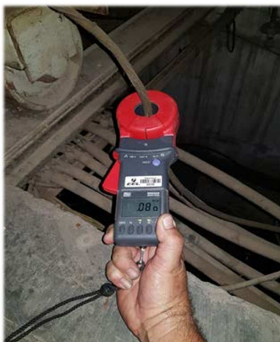
MEDIÇÃO DA MALHA DE ATERramento DOS TRANSFORMADORES
