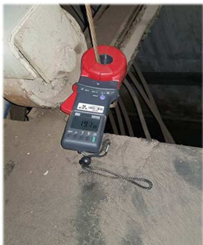
MEDIÇÃO DA MALHA DE ATERramento DOS TRANSFORMADORES
