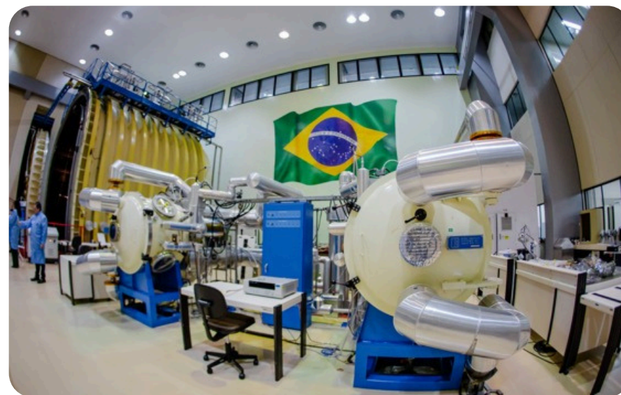
Figura 31 - Sistemas para testes vácuo-térmicos no LIT.
