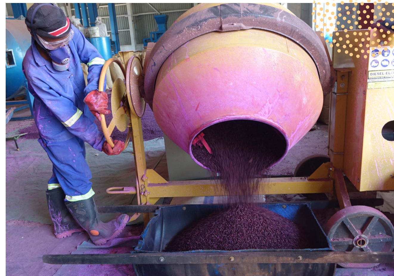
Deslincamento químico de sementes de algodão
