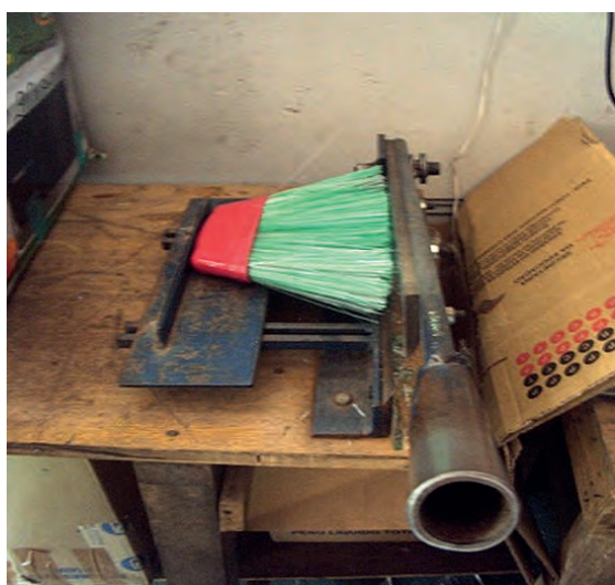
Figura 52 – Guilhotina para realizar o acabamento
