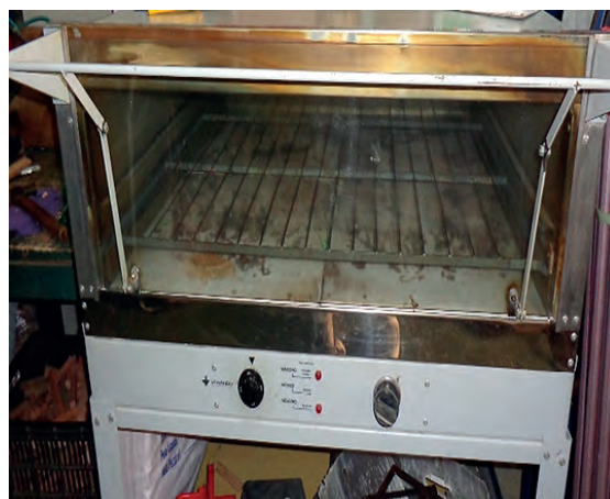
Figura 47 – Forno elétrico para endurecer os fios
