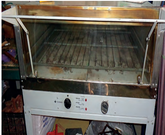
Figura 60 – Forno elétrico para endurecer os fios
