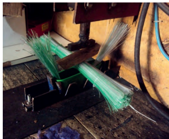
Figura 51 – Grampeador para prender os fios na capa da vassoura
