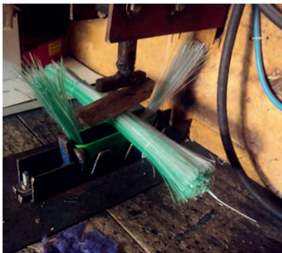
Figura 62 – Fios sendo montados no cabo da vassoura
