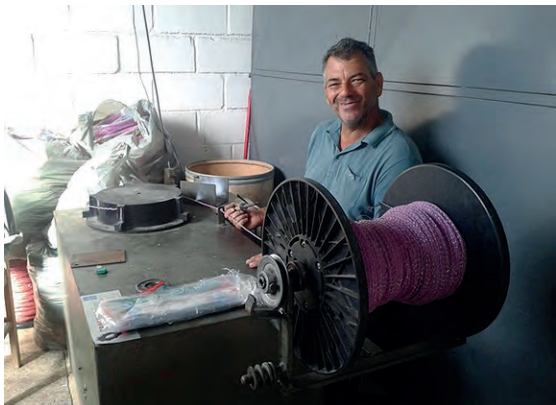
Figura 39 – Máquina que mede o tamanho da corda em que são embaladas
