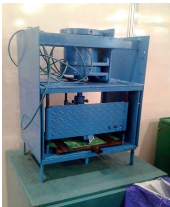
Figura 49 – Prensa para cortar fios da grade
