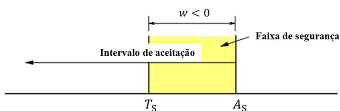
Figura 11 – Regra de decisão baseada em rejeição conservadora. Um limite superior de aceitação A_S fora de um limite superior de tolerância T_S define um intervalo de aceitação que reduz a probabilidade de rejeitar falsamente um item em conformidade (risco do produtor). O parâmetro de comprimento w associado a uma faixa de segurança de rejeição conservadora é w = T_S - A_S < 0 .
