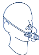
Figura 5 Exemplo de cobertura das vias respiratórias do tipo bocal com a pinça nasal (ISO 16975.1)
